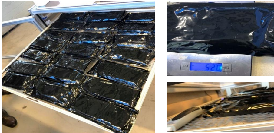
Figur 27: Testoppsett for test av PCM –blanding
