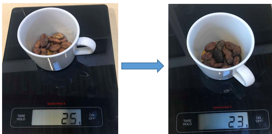
Figur 20: Vektendringen før og etter tørking i tørkeskap.
