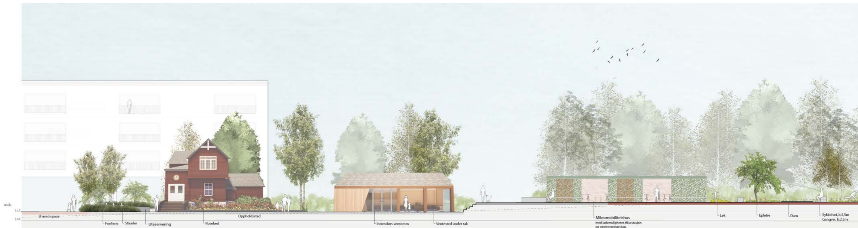
Fig. 174: Oppriss A-A': Oppriset viser bygningene på rekke langs vestre perrong, der den gamle stasjonsbygningen fremstår som den viktigste bygningen og det nye ventehuset og mikromobilitetshuset har et moderne uttrykk men underordner seg det gamle stasjonsbygget. (Målestokk 1:250).
