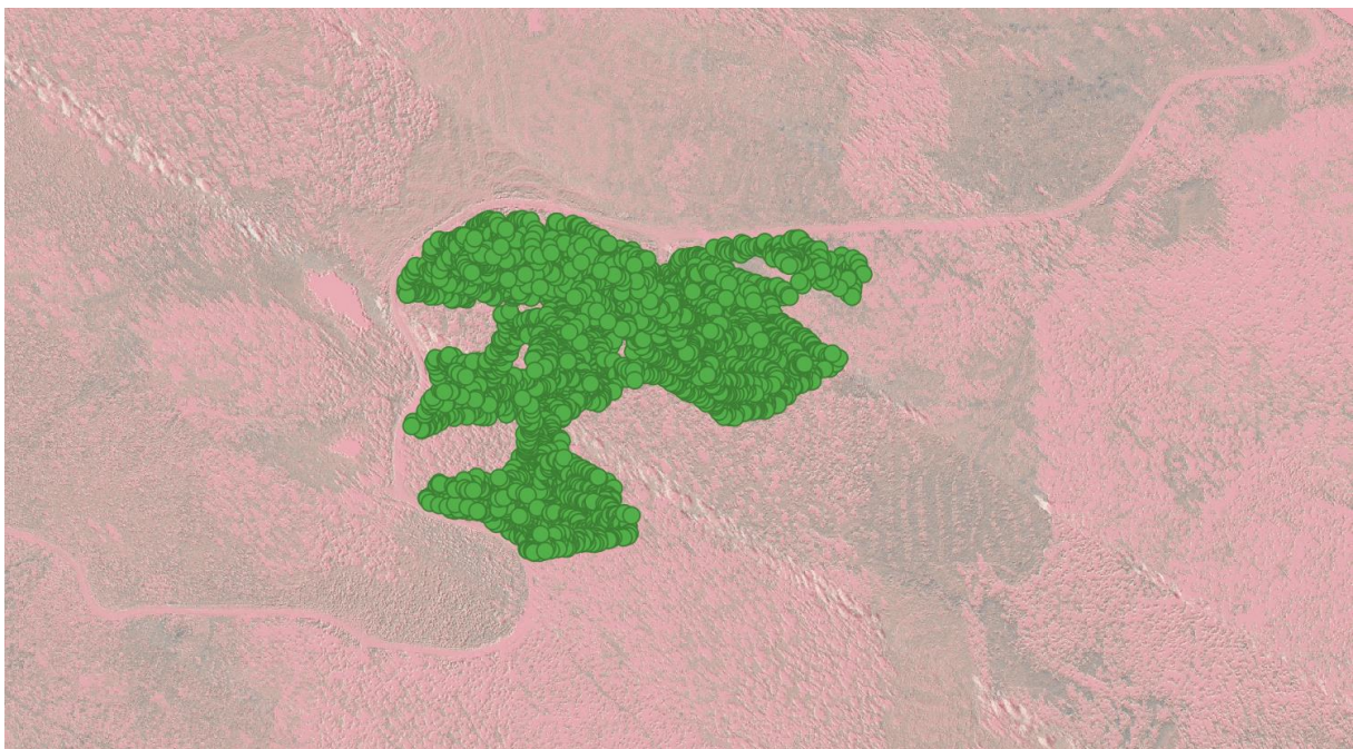
Figur 10: Kombinasjon av SWIR og VNIR som dekker hogstområdet. Det er tydelige forstyrrelser i kanten av flystripene.
