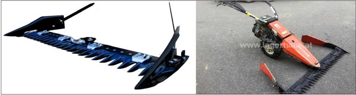
Figur 9.3: Eksisterende knivbjelker med en form for sideplater for å skyve unna klippet gress. [93, 94]
