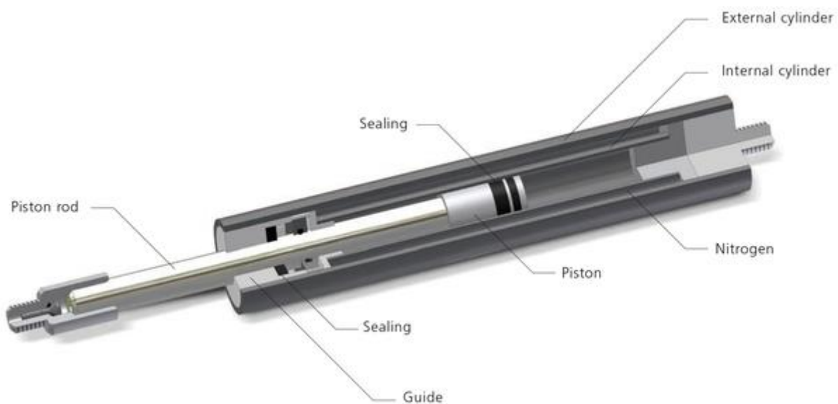
Figur 9.14: Et snitt av en dragende gassfjær. [102]
