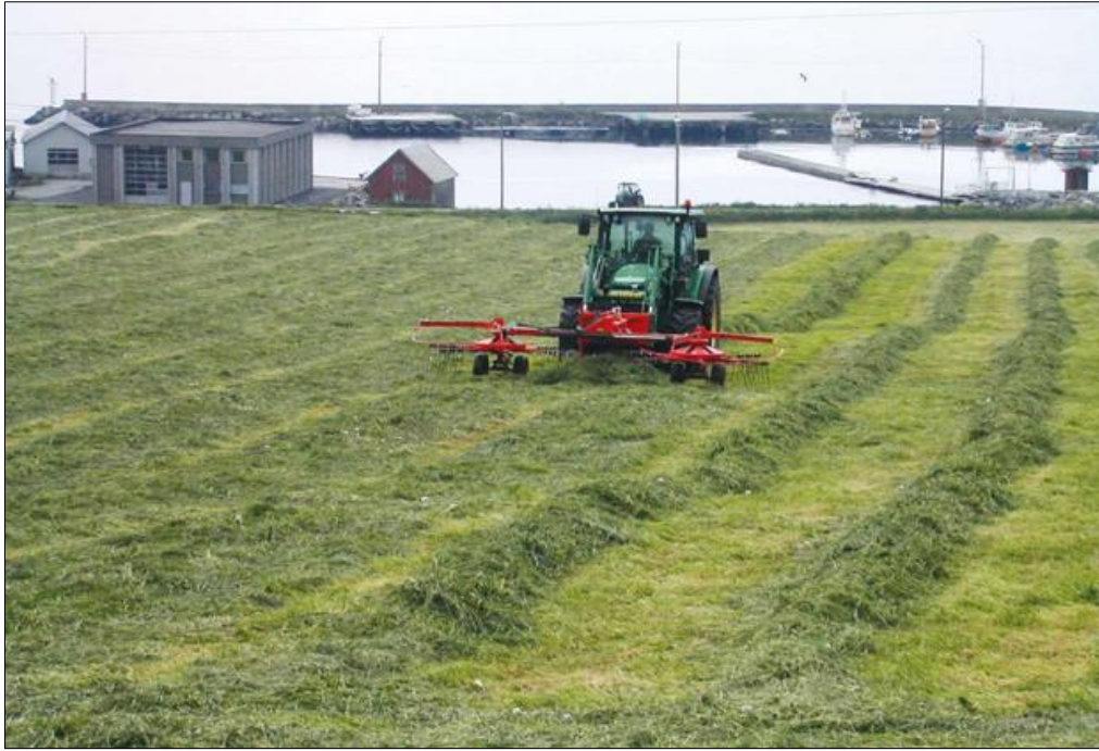
Figur 3.4: Bildet viser en samlerive som benyttes på breislått gress. [31]
