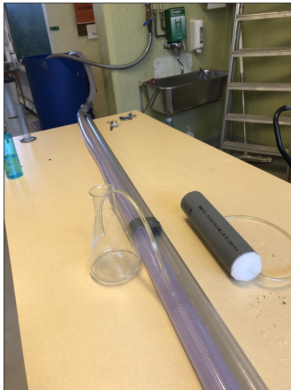
Figur 2.3: Bilde av friksjonsmåleutstyret: Innløp fra tank og PVC-slange til rør med stigerør. Foto: Vilde Ryen.
