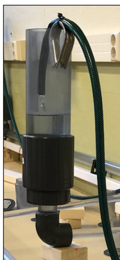
Figur 2.14: Utforming av kum i labmodell, i dette tilfellet en kjellerkum. Foto: Vilde Ryen.
