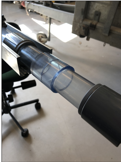
Figur 2.11: Bend til forsøk i del 1: Avløpsledning. Foto: Vilde Ryen.
