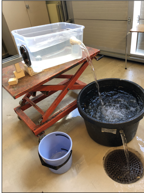
Figur 2.12: Utløp i forsøk i del 1: Avløpsledning. Foto: Vilde Ryen.
