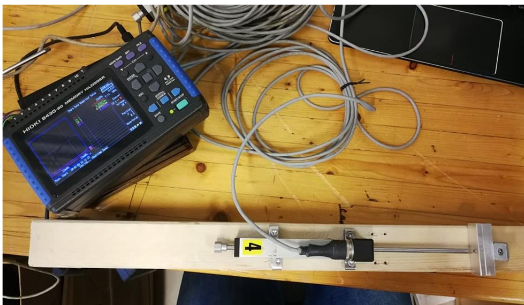
Figur 3.5-4 - Kalibreringsrigg for nedbøyningssensorer.
