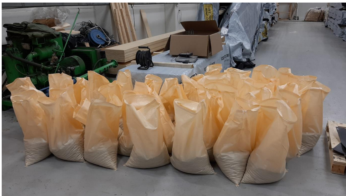
Figur 3.6-6 - Sekker fylt med singel for nedbøyningstest.
