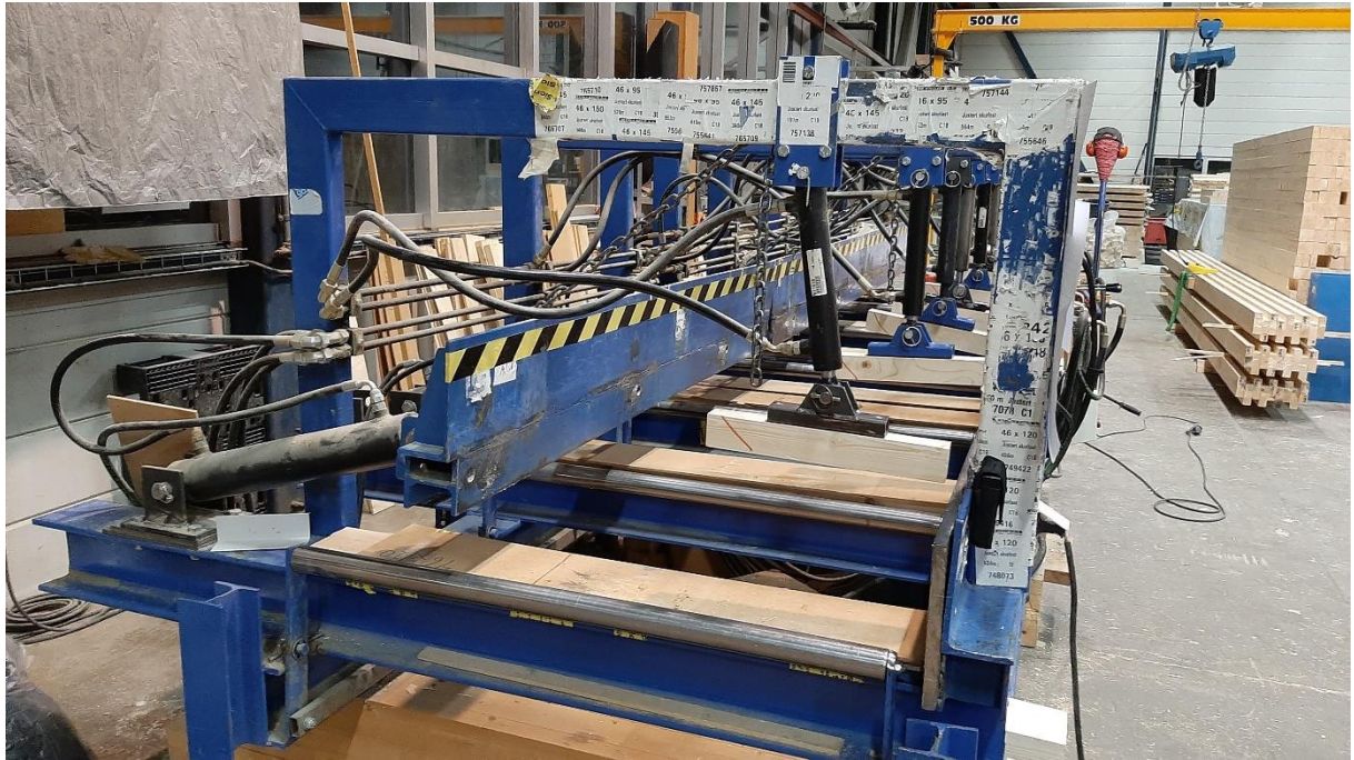
Figur 3.2-2 – Jiggen til Norsk Massivtre.
