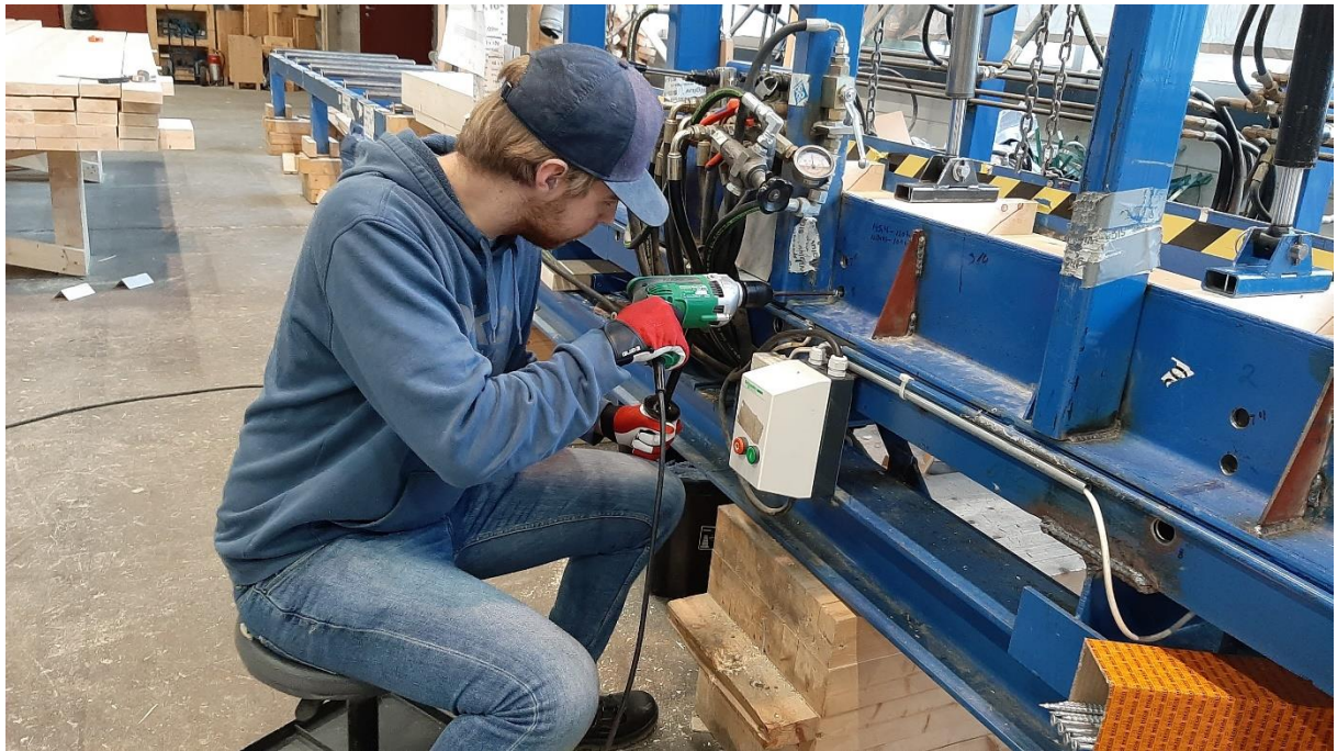
Figur 3.2-3 - Skruerull i jiggen og skruing av element.
