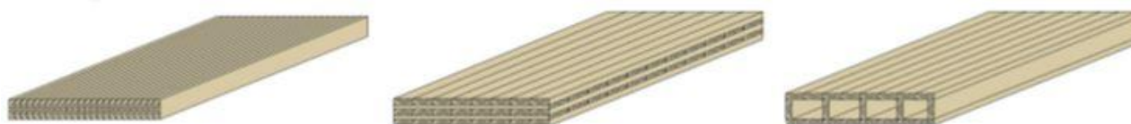
Figur 2.2-1 – Ulike typer massivtre. Henholdsvis kantstilt element, krysslagte element og hulromselement (Norsk Treteknisk Institutt, 2006).
