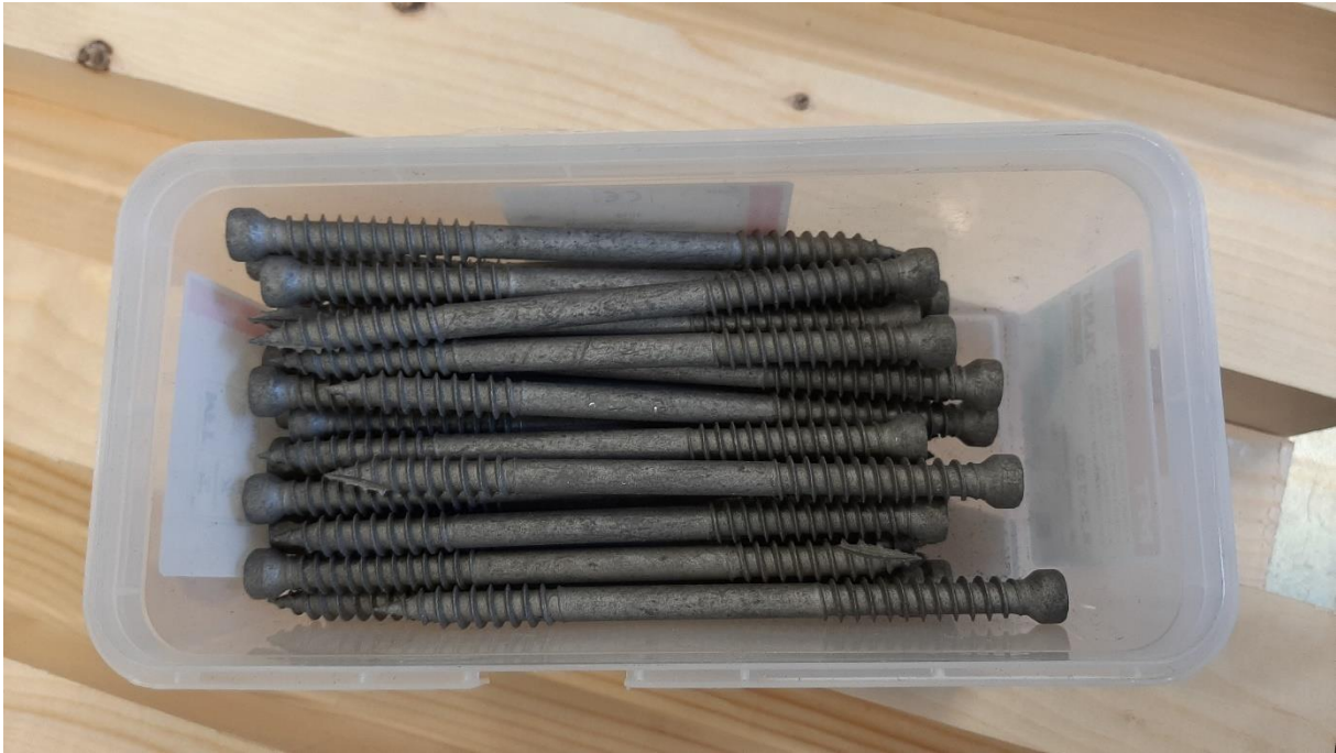
Figur 3.2-11 - Skruer brukt til å sammenføre elementer.
