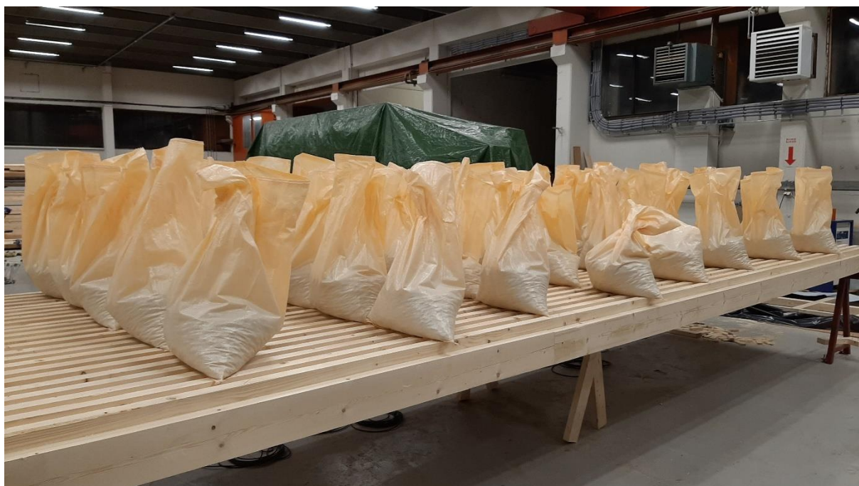
Figur 3.6-8 - Full last på massivtredekke 2.
