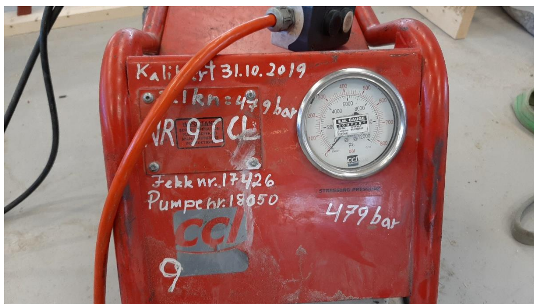
Figur 3.2-19 – Oppspenningspumpe, analog avlesning av trykk. Maks 479 bar.
