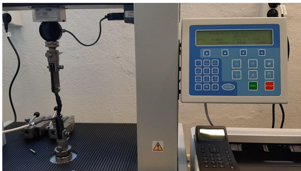
Figur 3.5-5 - Kalibrering av strekkklapper, leser av forskyvning og kraft på displayet til strekkmaskinen.
