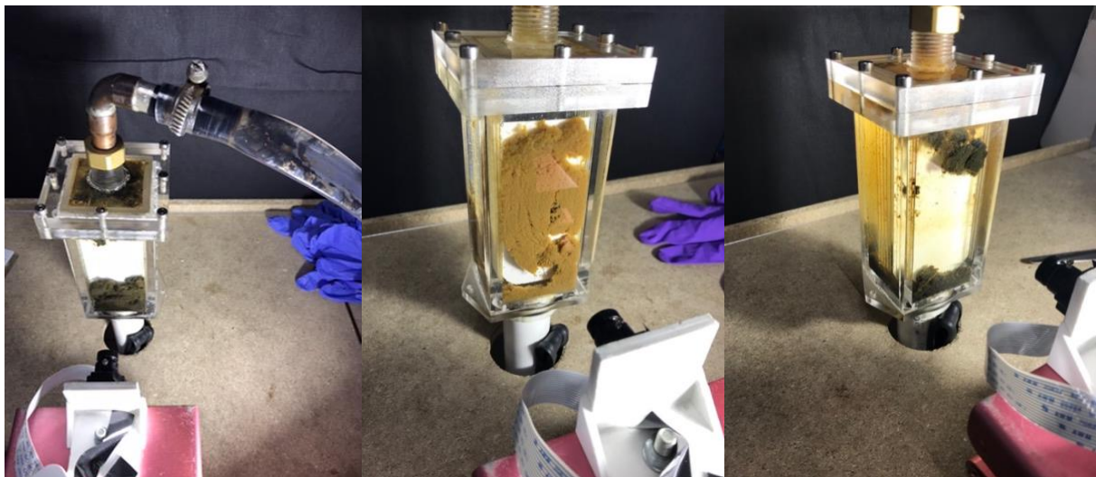
Figur 28. Gjengroing av kyvette og pumpe­slange
