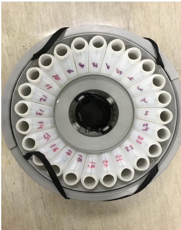
Figur 23. Karusellprøvetaker med 24 flasker a 400 ml
