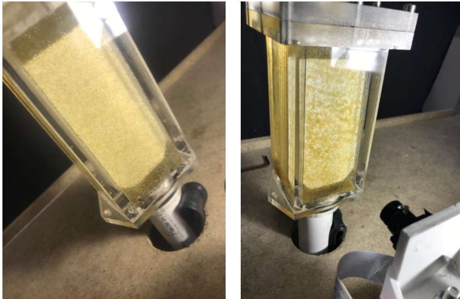
Figur 26. Visuell observasjon av endring i fnokkstruktur i kyvetten. Bilde til venstre viser små fnokker, bilde til høyre viser større fnokker
