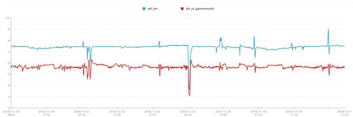
Figur 32. Endringer i pH. Blå linje er pH innløp og rød linje er pH utløp.
