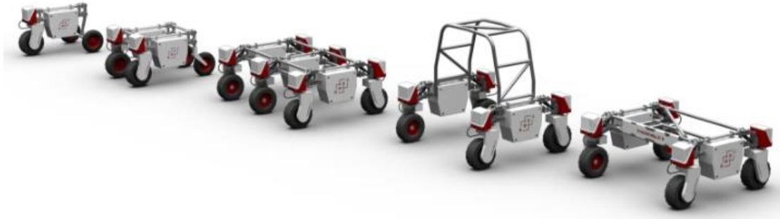
Figur 5. Fra venstre: En trehjuler versjon, en liten, smal versjon for drivhus, en differensial drevs versjon, en høy fenotypeversjon, en standardversjon.[9]
