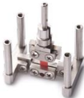
Figur 23: Festemekanisme for måling av strekk [47].
