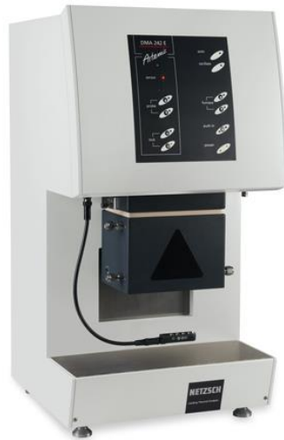
Figur 22: DMA 242 E Artemis frå produsenten Netzsch [47].
