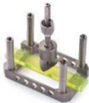
Figur 52: Tre-punkts bøyning av prøveobjekt. [47]
