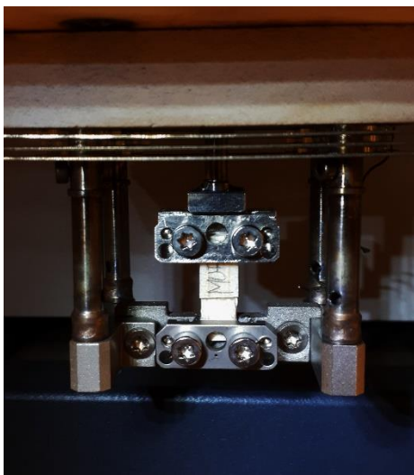
(A) - Prøveobjekt montert i DMA
