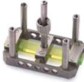
Figur 53: Enkel eller dobbel innfesting av prøveobjekt. [47]
