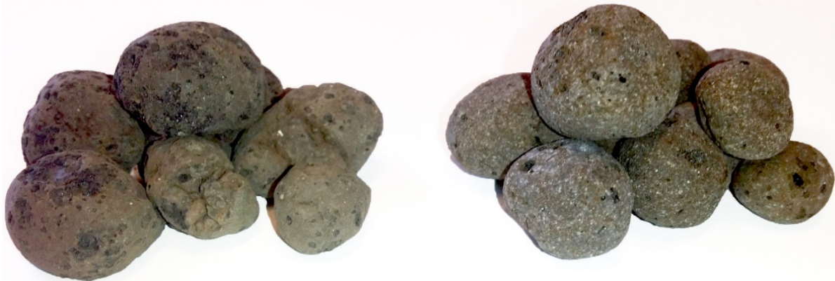
Figur 1. Til venstre: Leca type A (Leca® 10-20 round, produsert i Latvia av Saint-Gobain Weber A/S, Ølst, Danmark). Til høgre: Leca type B (Filtralite® NR 10-20, produsert av Weber Leca Rælingen, Norge, http://www.filtralite.com/en/home-page ).
