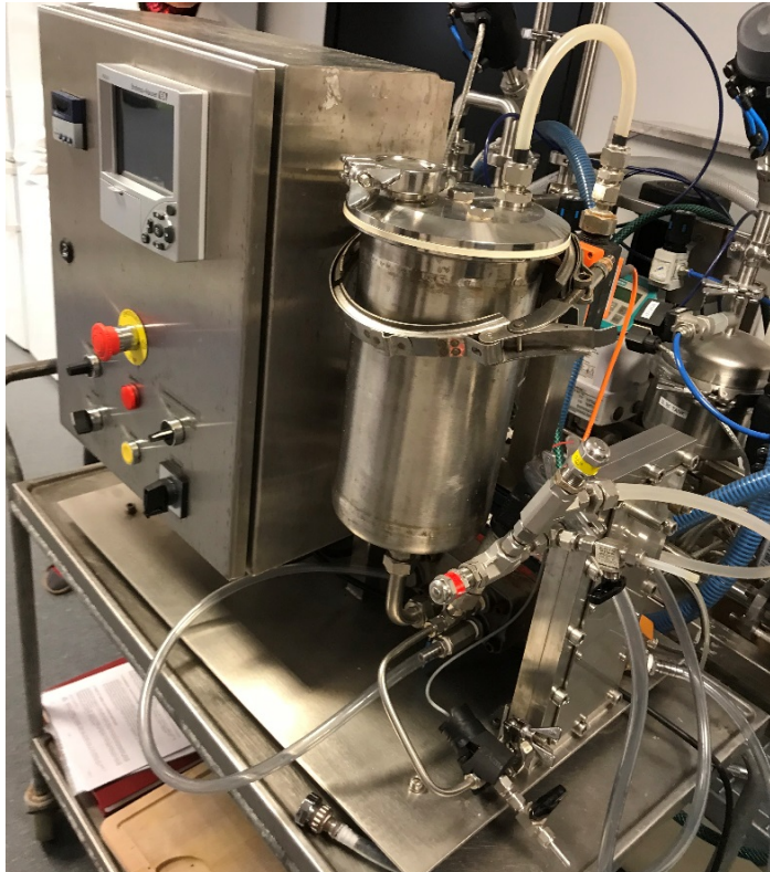
Figur 34: Pilotanlegget for batch-kjøring med flat-sheet membraner. Foto: AquaTeam COWI.
