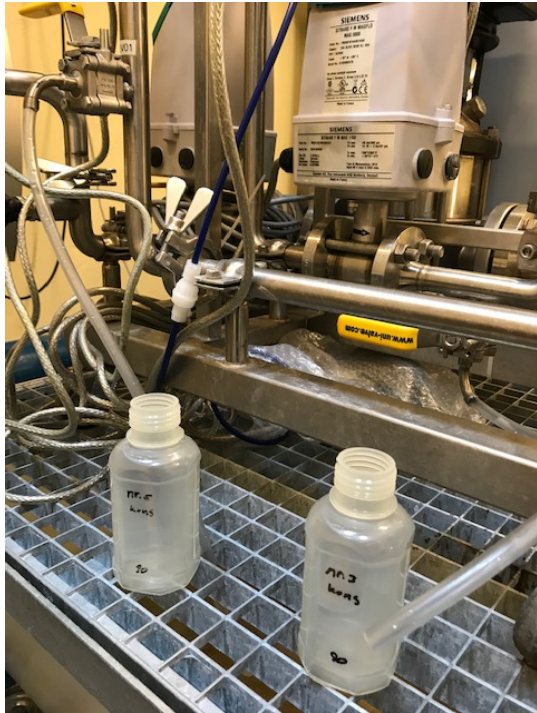
Figur 29: Manuell tappeventil med gummislange. Foto: Undertegnede
