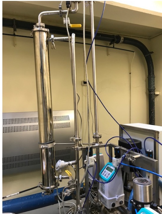
Figur 26: Membranhus med sideinnløp i bunn, vertikalt utløp av permeatet i toppen og sideutløp av konsentratet i toppen. Foto: Undertegnede.
