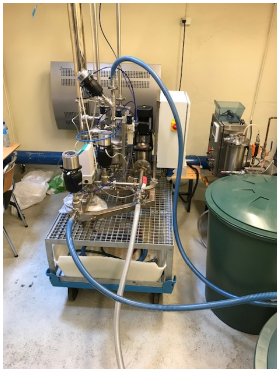
Figur 23: Oversiktsbilde pilotanlegg. Grå slange er innløpet, blå slanger er konsentrat (nederst) og permeat (øverst). Foto: Undertegnede.
