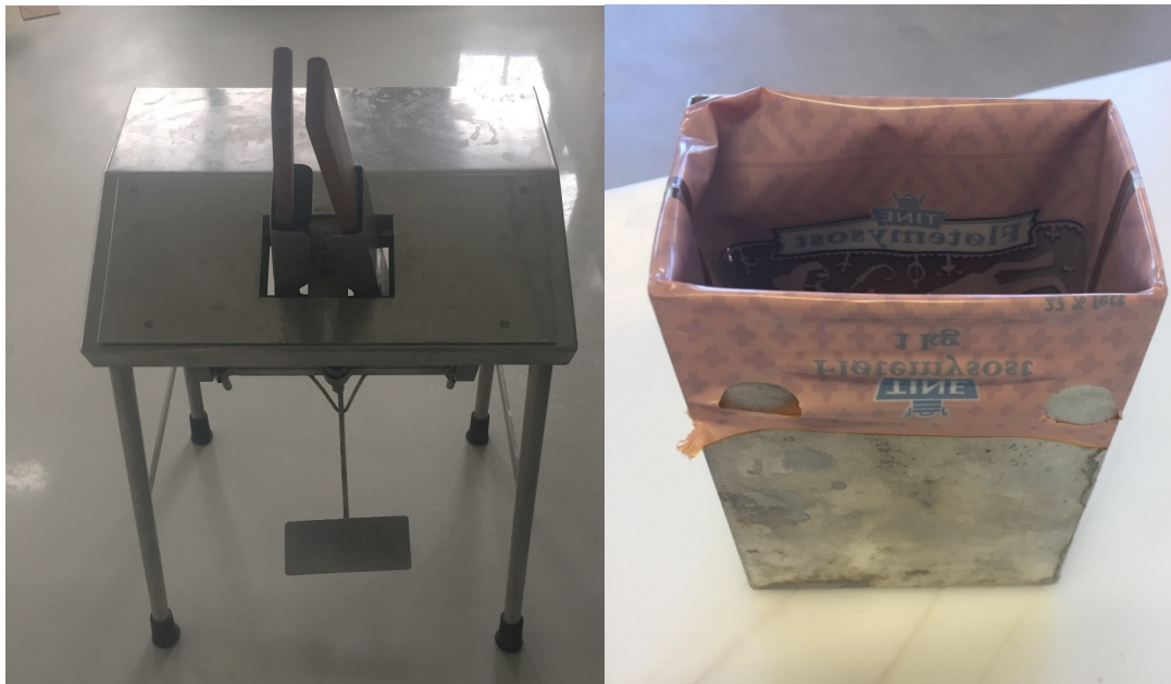
Figur 6. Pakkemaskin for brunostkassetter og ferdigpakket brunostkassett (Foto: Privat)
