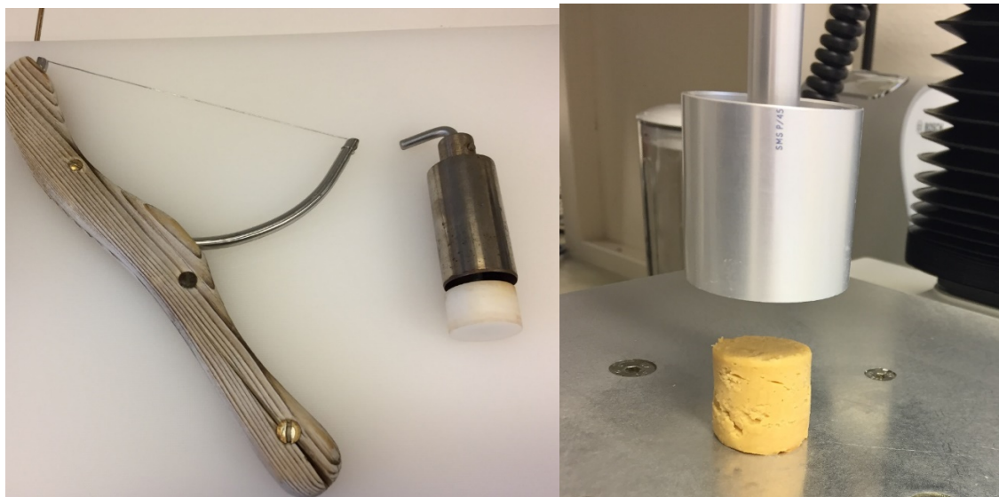
Figur 9. Utstyr brukt til prøveuttak for teksturanalyse og utstukket prøve til teksturanalyse (Foto: Privat)
