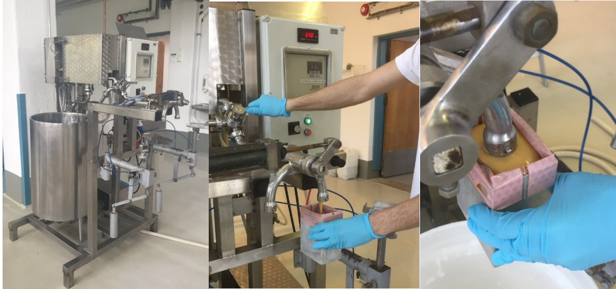
Figur 8. Pakkemaskin benyttet til pakking av brunost (Foto: Privat)
