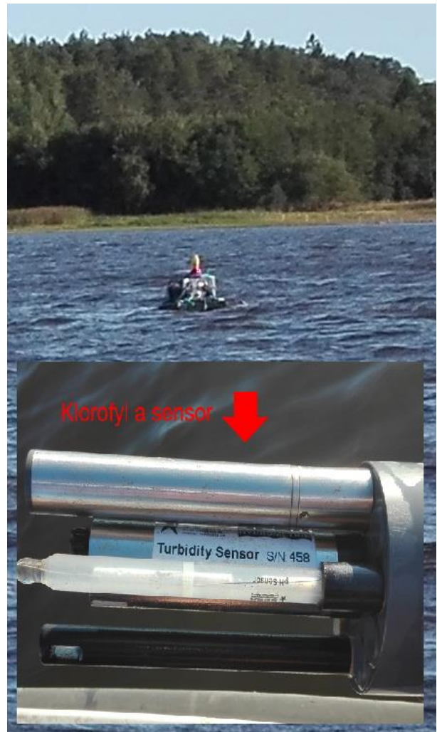
Figur 4: Billede af kassen indeholdende UniLogCom datalogger, bilbatteri og tilkøbet multimarametersensoren MPS-K16 fra SEBA Hydrometries (nederst). Billede taget fra Isesjøen, sommeren 2018
