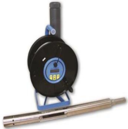
Figur 5: SEBA Hydrometrie KLL-Q-2 med sensor. Transportabelt måleinstrument til feltundersøgelser. Kilde: SEBA Hydrometrie
