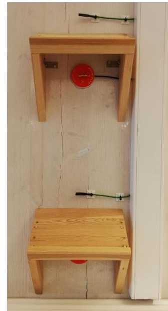
Figur 5-9 Innsiden av måleoppsett A. Den øverste sensoren måler mot tre og den nederste mot plastfilm på utsiden.
