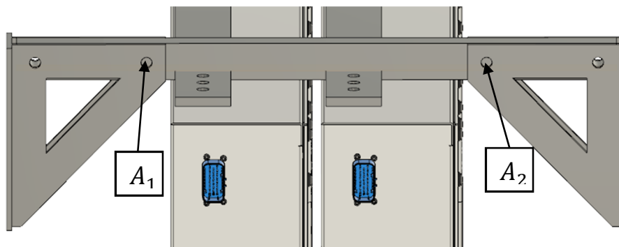
Figur 56: Bjelke ved opplager A.
