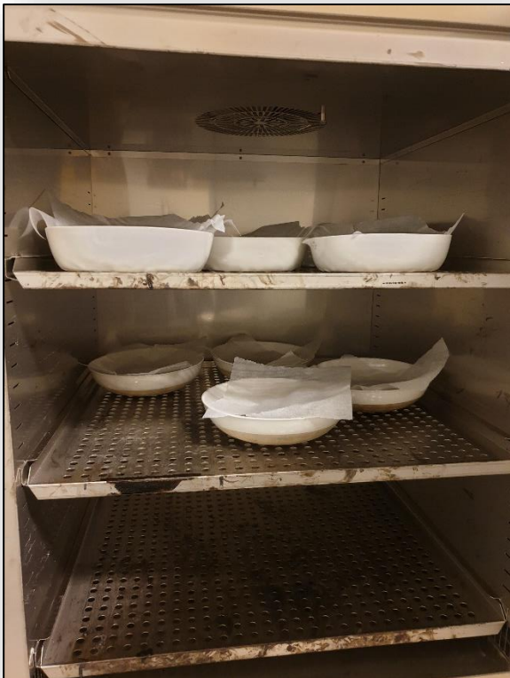
Figur B-2: Steinene før påføring av bindemiddel og etter påføring av bindemiddel
