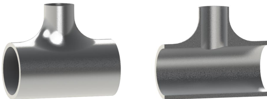
Figur 68: Bilde av komplett og snittet t-forgreining etter designforslag II. Ekstra gods påført i utsatt område, med en buet utforming.
