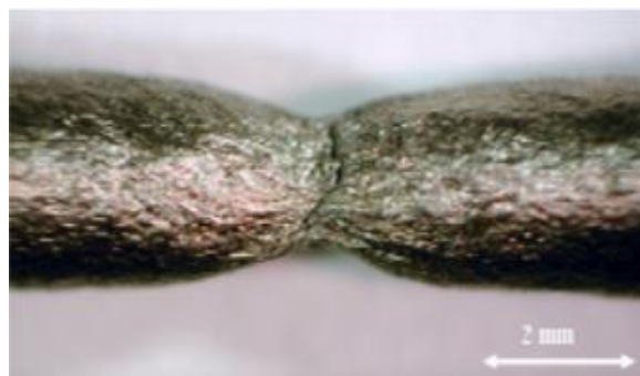
Figur 20: Brudd i luft ved 150 °C, enda større plastiske deformasjoner [34].
