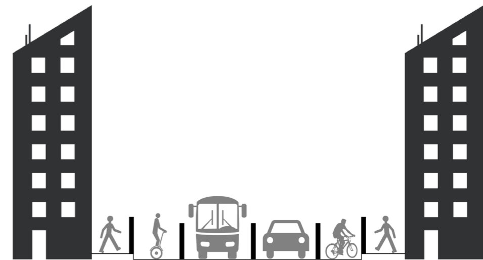
Figur 45: Mulig scenario med inngjerding av forskjellige trafikanter ved bruk av fysiske hindringer eller barrierer (Rosenlund, 2019).
