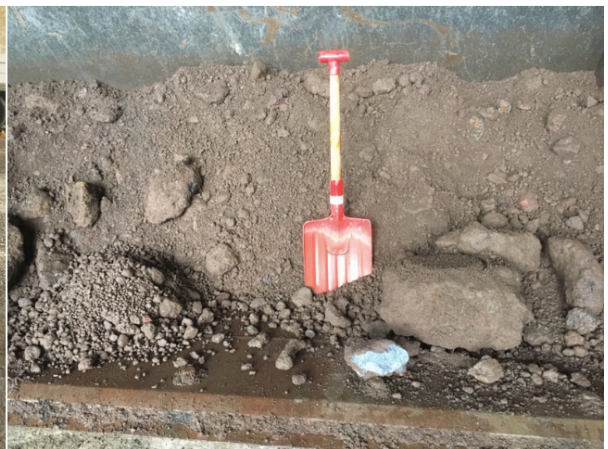
Figur 2.4: Her ser vi den jernholdige sorbenten som ble brukt i kolonneforsøket. Spaden på bildene er ca 1 m. Materialet ble siktet på 6.3mm før det ble overført i to stk 10L bøtter.
