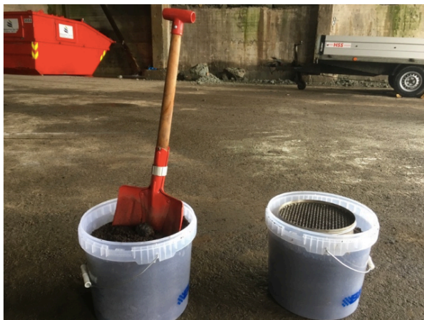
Figur 2.4: Her ser vi den jernholdige sorbenten som ble brukt i kolonneforsøket. Spaden på bildene er ca 1 m. Materialet ble siktet på 6.3mm før det ble overført i to stk 10L bøtter.
