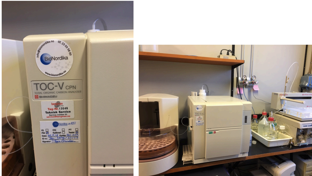
Figur 2.10: DOC, figuren viser apparatet som ble benyttet for å registrere mengden oppløst organisk karbon i vannprøvene.
