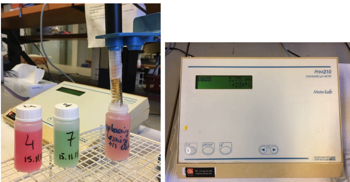
Figur 2.9: pH, dette apparatet ble benyttet for å finne pH-verdien i vannprøvene.
