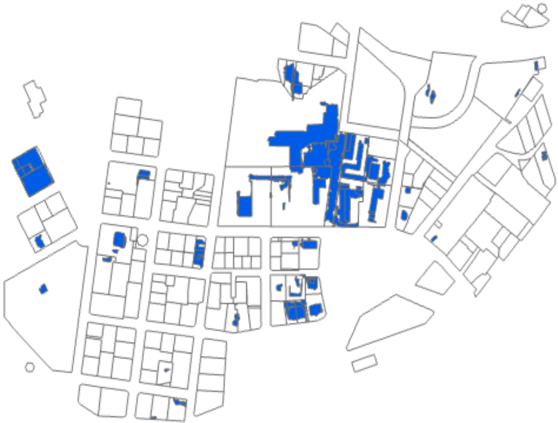
Figur 4.8: Resultat : «Tette flater med avrenning til terrengforsenkning»
