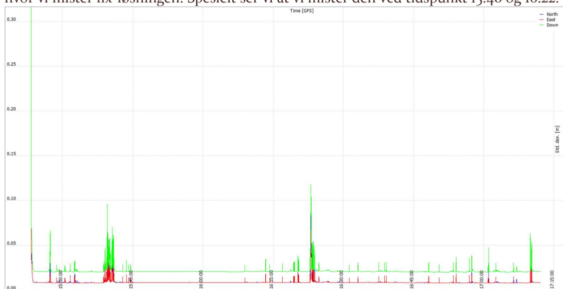
Figur 4.12: Presisjonsstandardavvik på posisjonsberegningen med DGNSS tur 2
