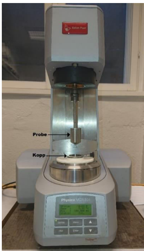
Figur 14. Reometer Physica MCR 301 fra Anton Paar (Østerrike) utstyrt med en konsentrisk probe (CC27/Ti, Anton Paar, Østerrike) og kopp (Measuring Cup-C-CC27/T200/Ti, Anton Paar, Østerrike) (Foto: Karima Eid Bacha).
