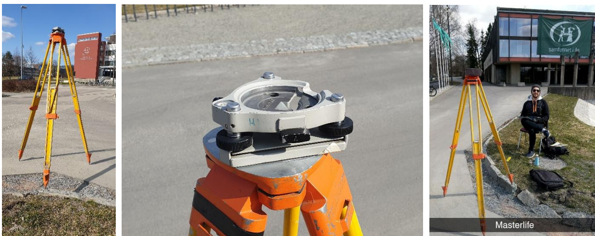
Figur 24 T.v.: Stativet som ble stilt opp over AUDM-punktet før innmåling. Midt.: Fotplaten som ble plassert oppå stativet. T.h.: En hardtarbeidende geomatikkstudent (Foto: Bendik Hassel).
