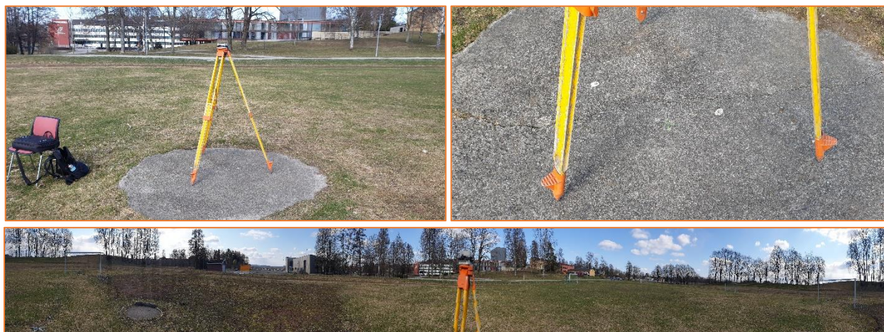
Figur 27 STRB sin oppstilling og betongsirkelen som ble brukt som flate til å stå på. Panoramabilde mot nord.
