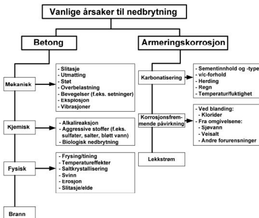
Figur 2.16: Nedbrytningsmekanismer (Standard Norge, 2008)
