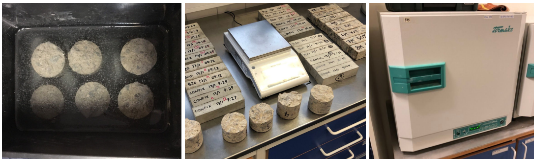
Figur 3.11: a) Vannlagring av prøver b) Veiing av prøver c) Tørking av prøver
