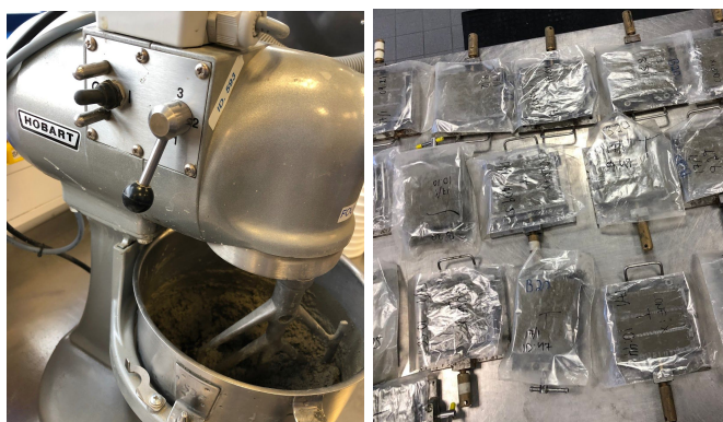
Figur 3.4: a) Blanding av mørtel b) Utstøpte prøvelegemer
