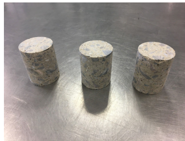
Figur 3.13: Ferdig planslippede betongkjerner til trykktesting
