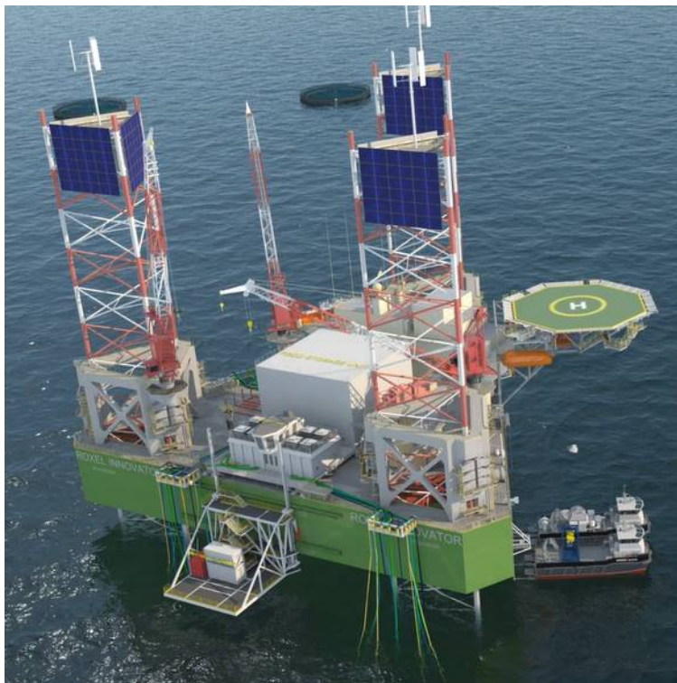
Figur 2 Illustrasjon av Octopus. På toppen av rigg-føttene er det montert solcellepanel og vertikalakslede vindturbiner.
