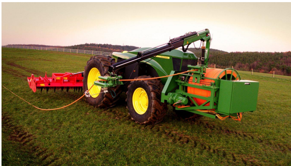
Figur 2 - illustrasjonsbilde av John Deere sin nye elektriske traktor "GridCON" med 1 km kabel tilknyttet strømmettet.
