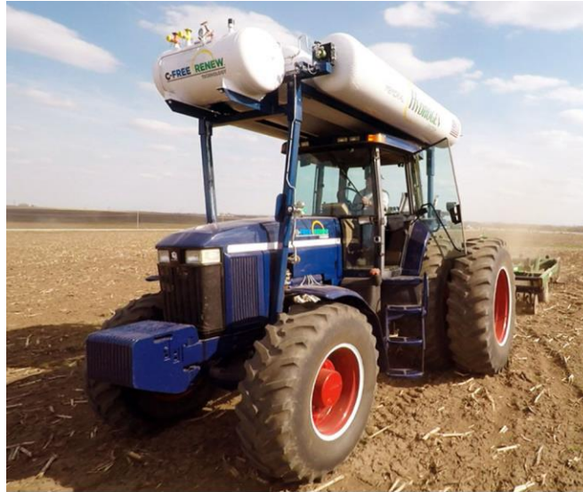
Figur 1 - illustrasjonsbilde av den ombygde John Deere 7810 med hydrogen og amoniakktank (Schmuecker, 2018).
