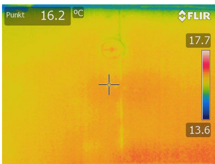
Lekkasjer ut av gipsskjøt (0.79 m/s) og stikkontakt over inngangsdør (0.91 m/s). Bilde til høyre viser hvordan det ser ut bak gips.
