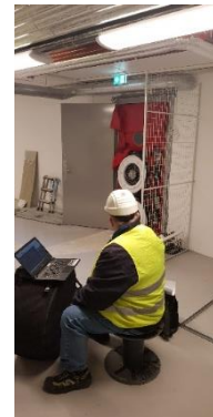
Figur 9 - Trykktesting med Termografi og Måleteknikk AS. Foto: Edvard Hogstad
