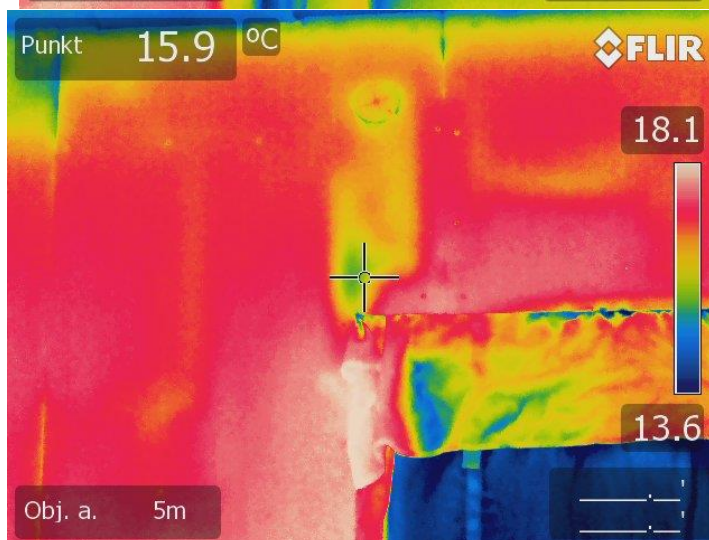
Luftelekkasjer over inngangsdør, luftstrømmer bak gips og ut av el-boks (1.38 m/s) Bilde nederst til høyre er før montering av gips
