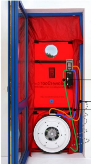
Figur 26 - Oppkobling av BlowerDoor Gjengitt med tillatelse fra The Energy Conservatory
