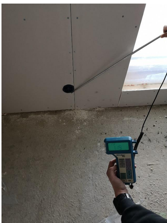
Lekasje ut av el-boks i yttervegg (1.19 m/s) ser kald luft bak gips
