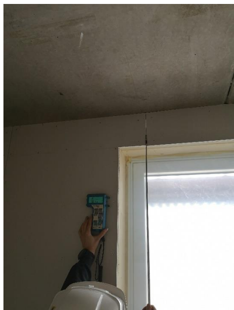
Lekkasje ut av gipsskjøt (0.73m/s)
