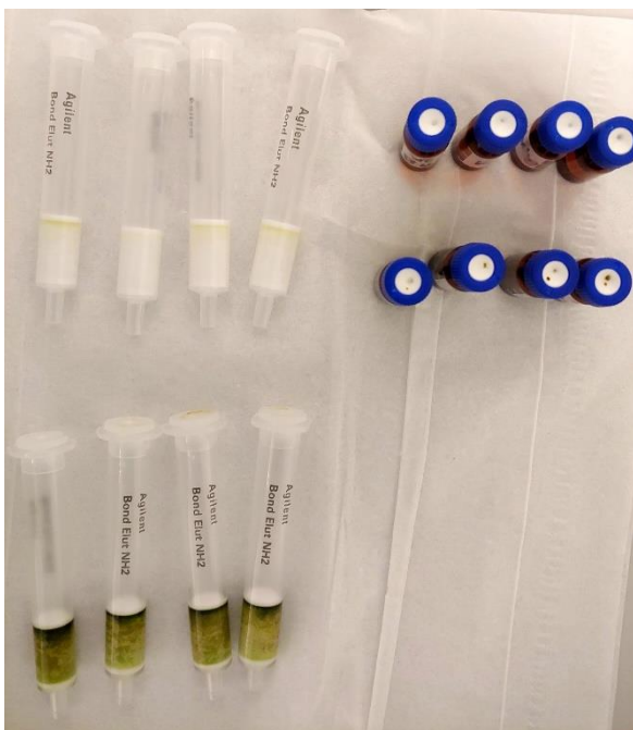
Figur 2: Figuren illustrer prøveoppsettet på SPE og tilhørende kolonner etter bruk. Det var et eksempel fra analysen av L. hyperborea (blad). Rekkefølge; rad 1: ekstraksjons-blank, ren kloroform, ren kloroform, ren kloroform, rad 2: replika 1, replika 2, replika 3, replika 4.
