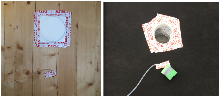
Figur 7.3.2 Trykkslanger plassert under ventilåpning inne og ute (Foto: Nina Johanne Brænden)
