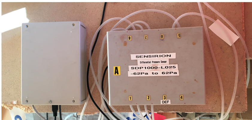
Figur 7.2.2 Trykkslanger under oppkobling til måleapparatet Sensirion (Foto: Nina Johanne Brænden)
