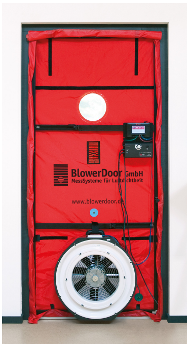
Figur 7.2.1 Blowerdoor 4.1 (BlowerDoor GmbH, 2018)
