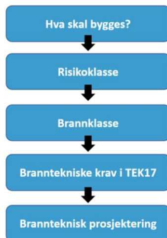
Figur 8. Innledende brannteknisk prosjekteringsprosess fritt illustrert etter Arumungam, A. (2018). Probabilitisk og deterministisk analyse av brannforløp i høye trehus: NTNU.
