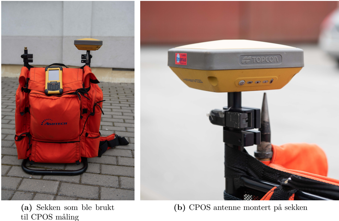
Figur 3.4: Utstyret brukt til CPOS-måling.
