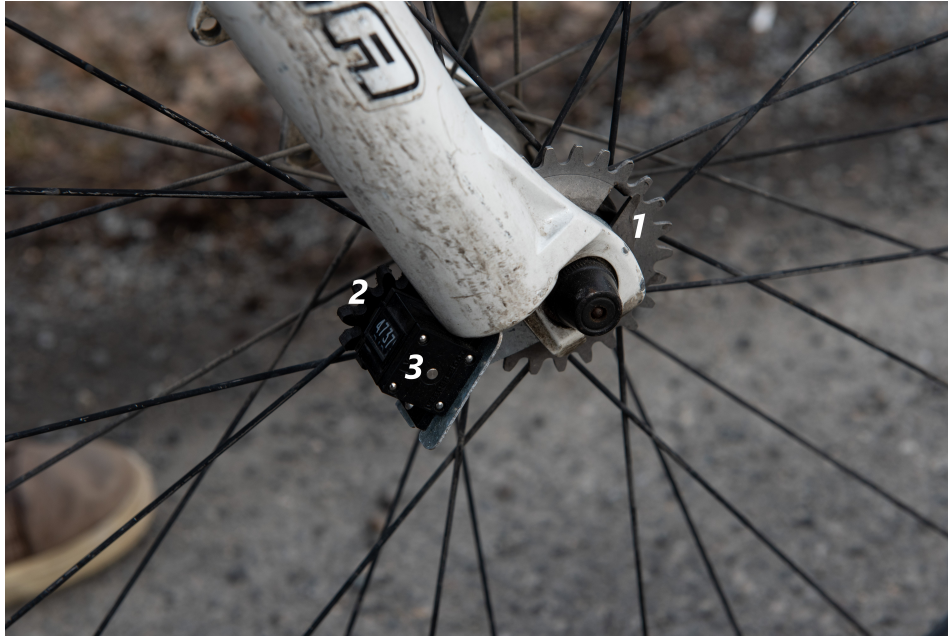
Figur 3.3: Hvordan en JC fungerer: På det store grå tannhjulet (1) sees et hull. På baksiden av hullet er det en tagg som griper tak i en av eikene, slik at tannhjulet snur sammen med forhjulet. Denne bevegelsen driver det mindre sorte tannhjulet (2). Akslingen som (2) sitter på driver en mekanisme inni telleboksen (3) som øker eller reduserer tallet som vises avhengig av om bevegelsen er framover eller bakover.
