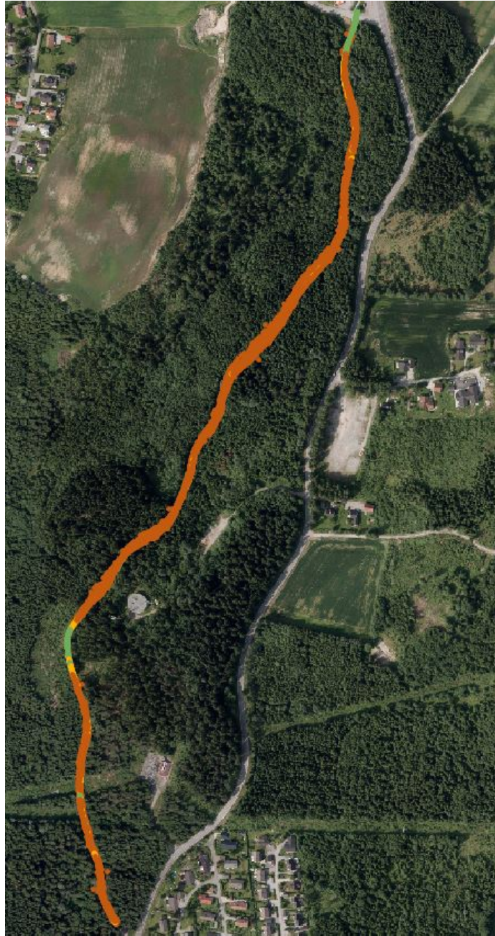
Figur 4.2: Hvert punkt i Askjumskogen har blitt fargelagt basert på om det er fix-løsning (grønn), float-løsning (gul) eller kodeløsning (brun). Etersom løypesporene ligger lagvis, kan det se ut til at det er et område med fix som er skjult i søndre del av ruta, men ved å se på de andre sporene som ligger under er det ikke mer enn det som vises her som er fix-løsning.
