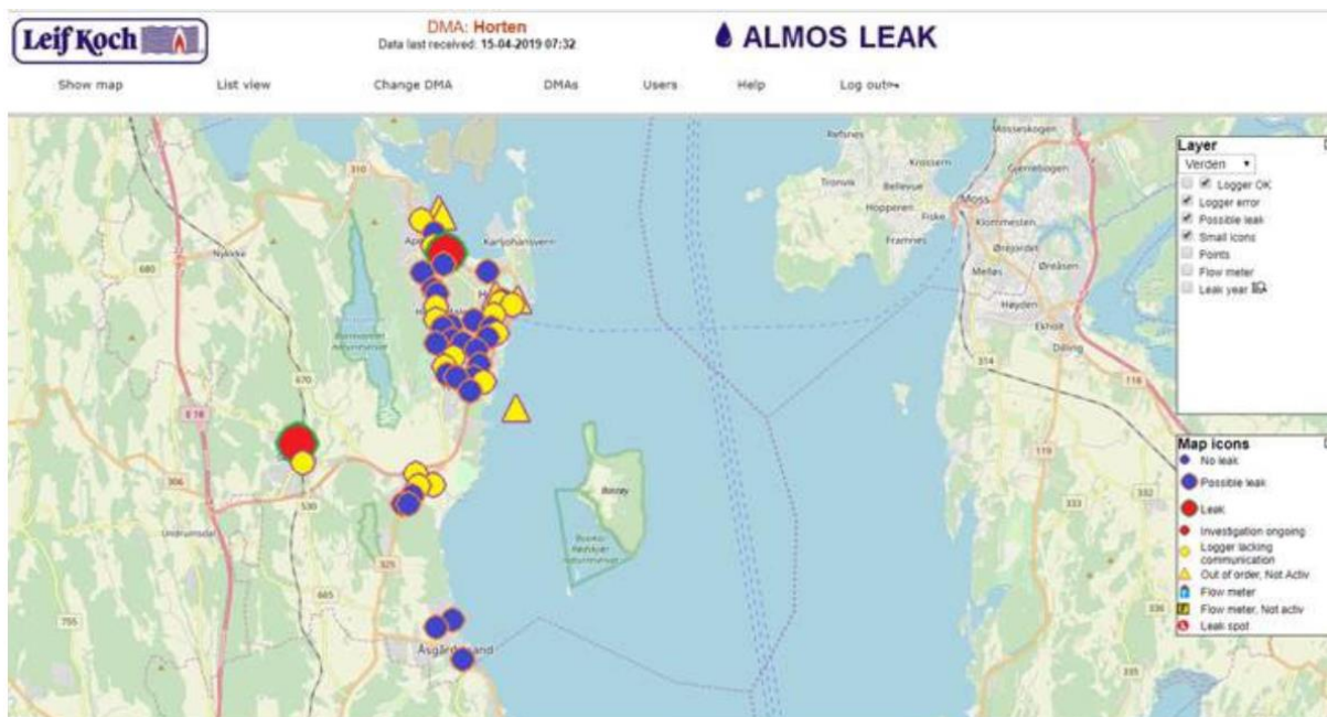
Figur 32: Lydloggere i Horten kommune. Symbol og farge indikerer om lydloggeren registrerer lekkasjer eller ikke. Liten blå runding indikerer at det ikke registreres noen lekkasje, mens stor rød runding indikerer at det registreres en lekkasje. Gul runding indikerer at lydloggeren mangler kommunikasjon, mens gul trekant indikerer at loggeren er ute av drift.
