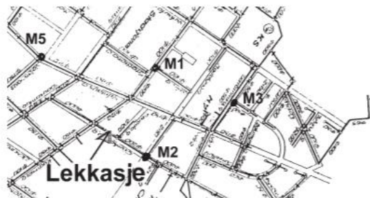
Figur 11: Ut plassering av lydloggere på ledningsnett. M1, M2, M3 og M5 indikerer en utplassert lydlogger. Lekkasjen ligger nærmest M2, og lyden vil dermed være kraftigere i denne lydloggeren. Når lydbildet fra alle lydloggerne sammenliknes kan man anta lekkasjens posisjon (SCC Prosjektering, 2008b).
