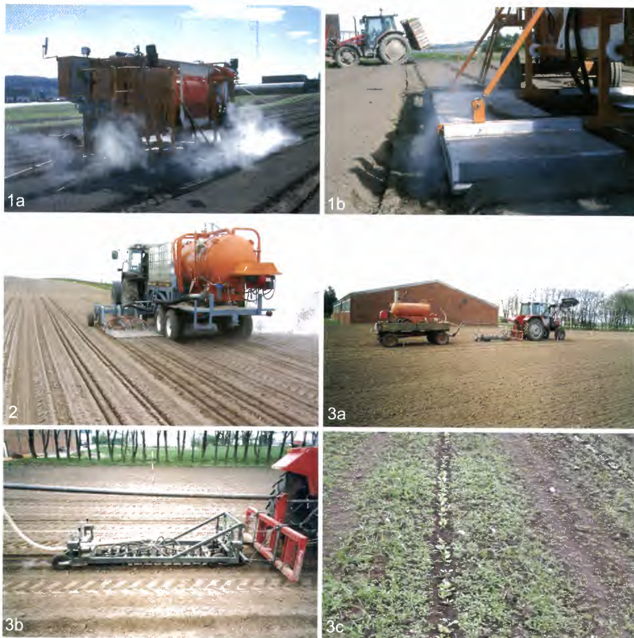
Figur 4.18 Utstyr for jorddamping på friland. Jorddamping over hele arealet er ikke tillatt i økologisk landbruk i dag, men utvikling av stripedampeutstyr kan gjøre metoden aktuell.
