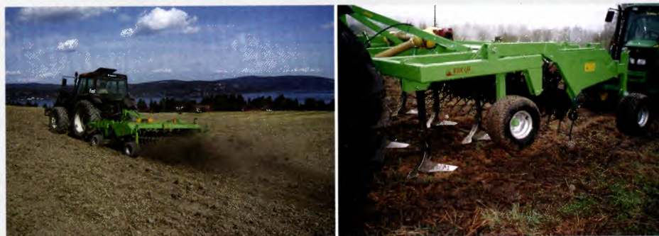
Figur 2.27 Kvik-Up harven er effektiv til å legge kvekejordstengler på jordoverflaten, men krever stor motorkraft.
