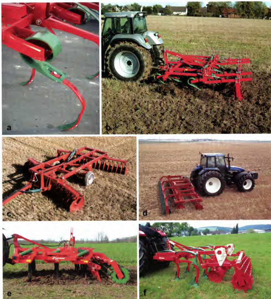
Figur 3.21 Ulike jordarbeidingsredskaper. a: Brede S-tinder. b: Stubbharv. c: Tung skålharv med V-forme. d: Skålharv hvor hver skål sitter på eget oppheng. e: Stive tinder med utløser, Q-formede tinder som etterharv. f: Skålgrubber. Fabrikat og foto alle bilder: Kverneland (gjengitt med tillatelse fra Kvernelands nettside).
