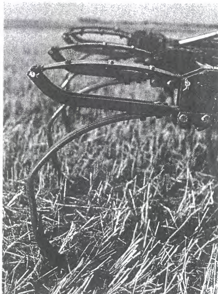
Figur 3.17 Fjærende tinder med utløser. Foto: NN.
