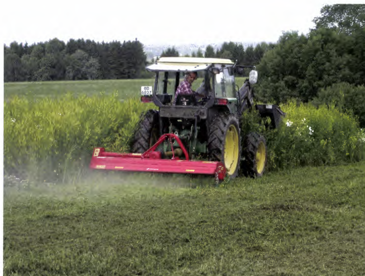
Figur 3.7 Gras- og halmsnittere er effektive til å kutte ned og knuse selv svært kraftige grønngjødslingsvekster. Bildet viser nedkutting av en frodig bestand av legesteinkløver. Foto: Lars Olav Brandsæter.
