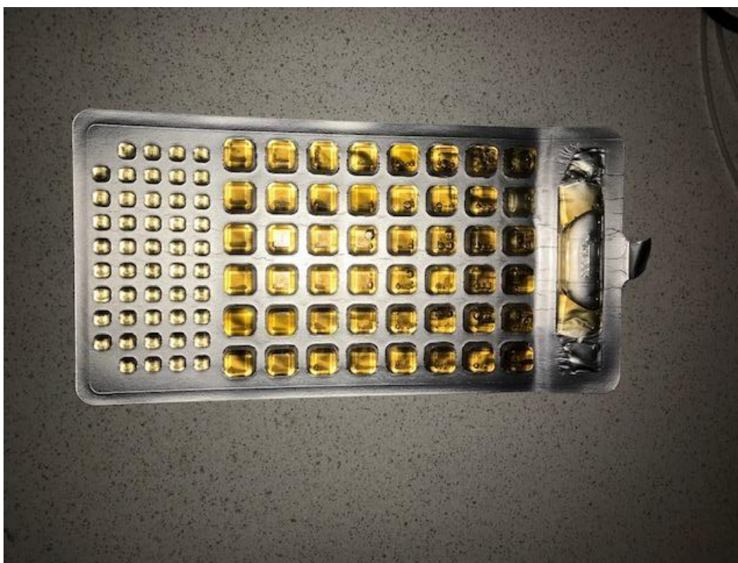
Figur 16: Fremstilling av IDEXX Qty-2000 MNP table klargjort for inkubasjon. Foto: Lukas P.F Hansen
