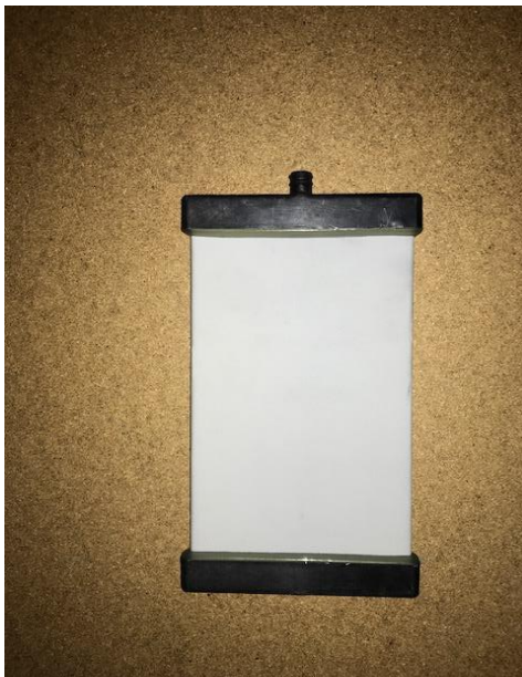
Figur 44: Keramisk membranplate 10x15cm BxH med bunn og topplokk for plastkassett. Foto: Lukas P.F Hansen
