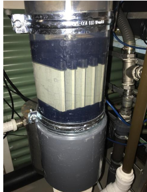
Figur 43: Konfigurasjonen av de 5 keramiske membranene. Foto: Lukas P.F Hansen
