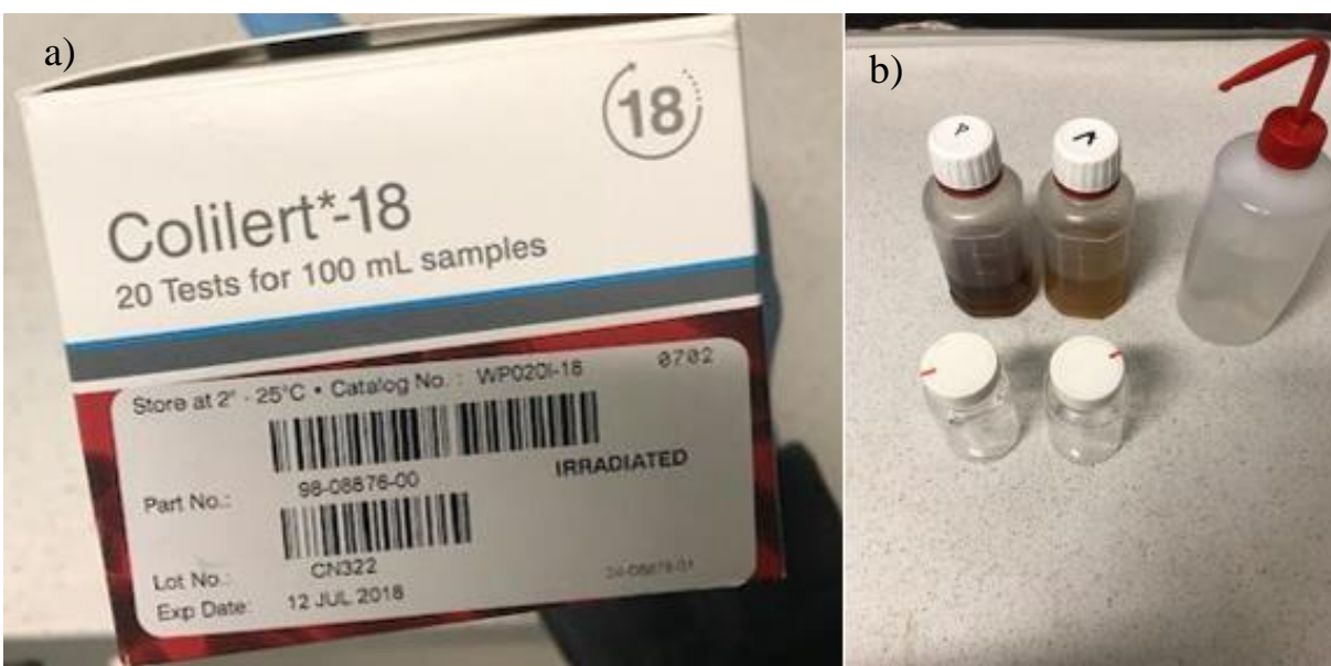
Figur 15: a) Colilert 18 test kit, b) oppsett for analyse av E. coli og koliforme bakterier med sterile plastbeholdere (nederst) og destilert vann (høyre). Foto: Lukas P.F. Hansen
