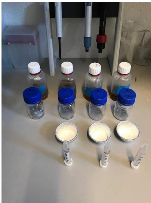
Figur 13: Standardoppsett for labarbeid. 1: væskeprøver fra anlegget, 2: glassbeholdere for filtrering, 3: alluminiumsbeger og filter og 4: plastbeholdere for samling til VFA-analyse. Foto: Lukas P.F. Hansen.
