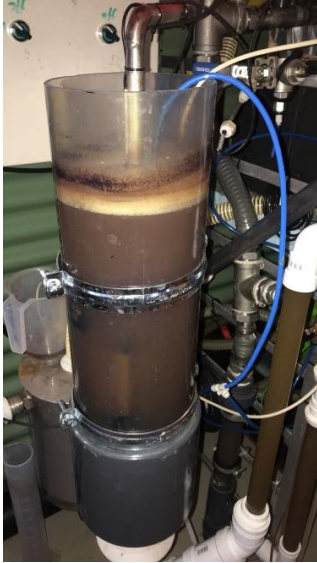
Figur 38: Skumnivå og skumfarge etter 5 driftsdager ved oppstart av første driftsperiode. Foto: Lukas P.F Hansen
