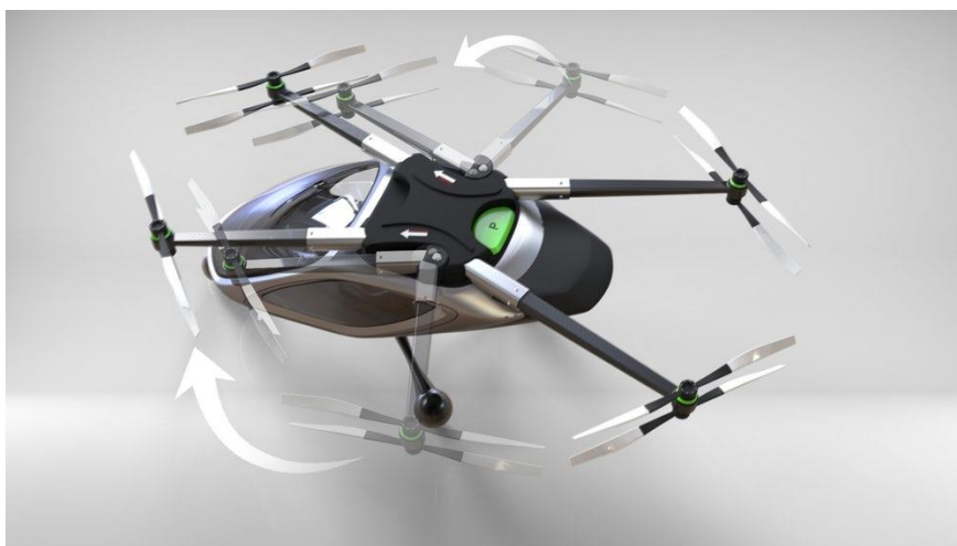
Figur 4.16: Konseptet er kun designet for flyvning. Sammenfolding av resterende armer er derfor ikke hensiktsmessig [16].
