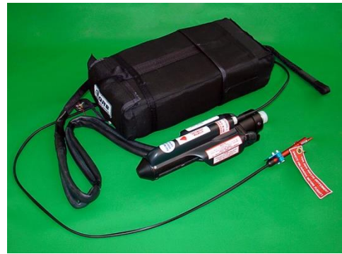
Figur 11.11: Bildet viser GRS 5 systemet med tilhørende fallskjerm og rakett [40].
