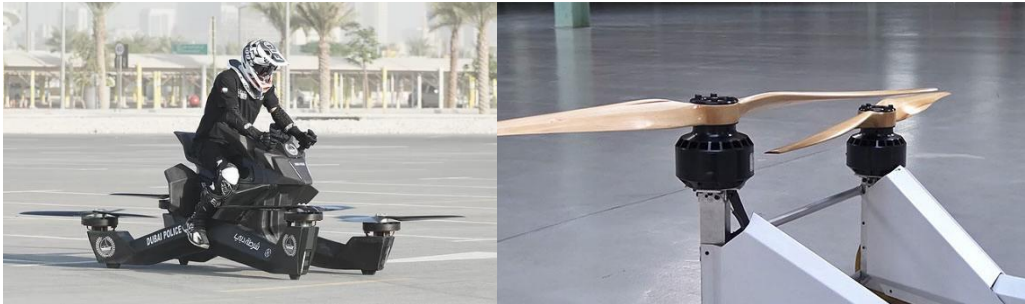
Figur 4.17: Til venstre gjennomføres det en testflyvning av Hoverbike [17]. Til høyre kan man se at propellene på bak og fremsiden er i ulik høyde, for at propellene skal unngå hverandre ved rotasjon [18].
