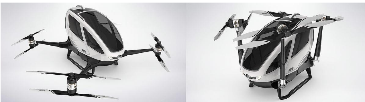
Figur 1.19: Ehang 184 viser dronen i sin helhet til venstre [12]. Til høyre ser man dronen når propellarmene er foldet sammen, i denne konfigurasjonen er det fortsatt mulig å åpne dørene [13].
