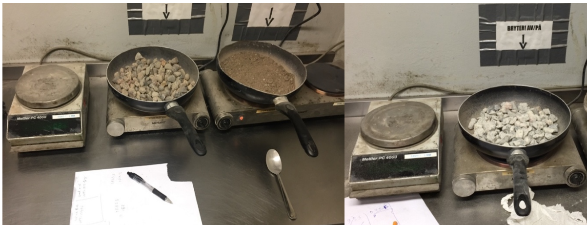
Figur 4-4. Måling av vanninnhold i tilslag.
