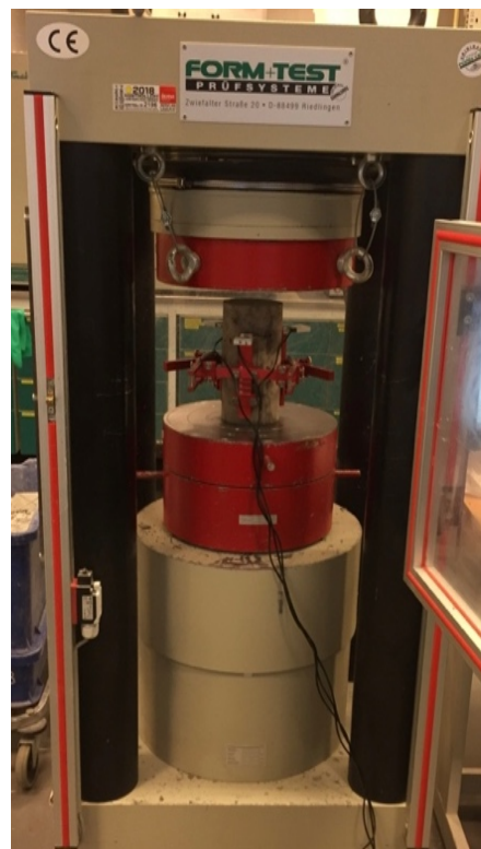
Figur 4-13. Testing på E-modul i Statens Vegvesen sin lab.
