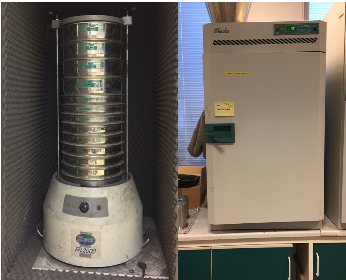
Figur 4-3. Siktmaskin som ble brukt i studien til venstre og til høyere vises det ovnen.
