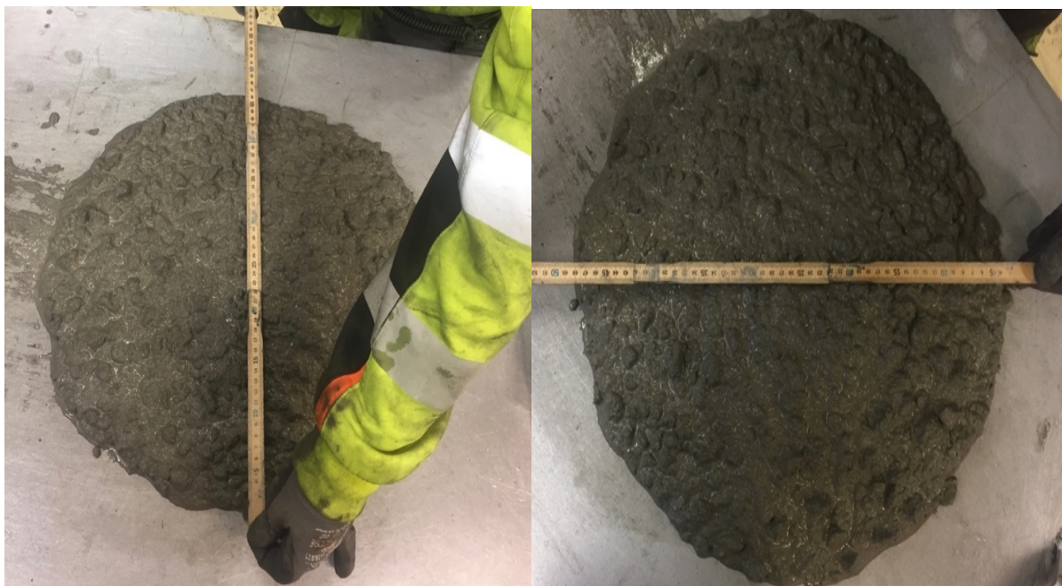
Figur 4-8. Måling av synkutbredelsesmål.
