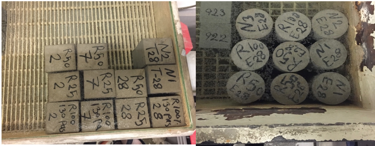
Figur 4-11. Herding av terning og sylindre i vannbad.
