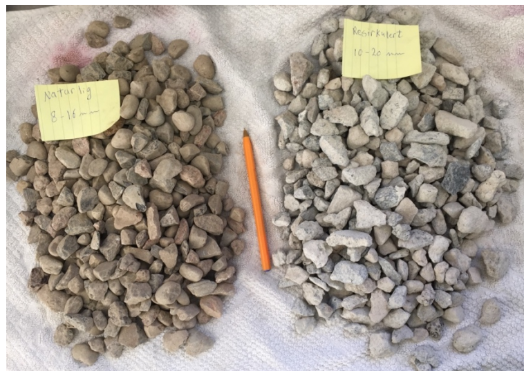
Figur 3-4. Sammenligning mellom naturlig tilslag til venstre og gjenvunnet tilslag til høyere.
