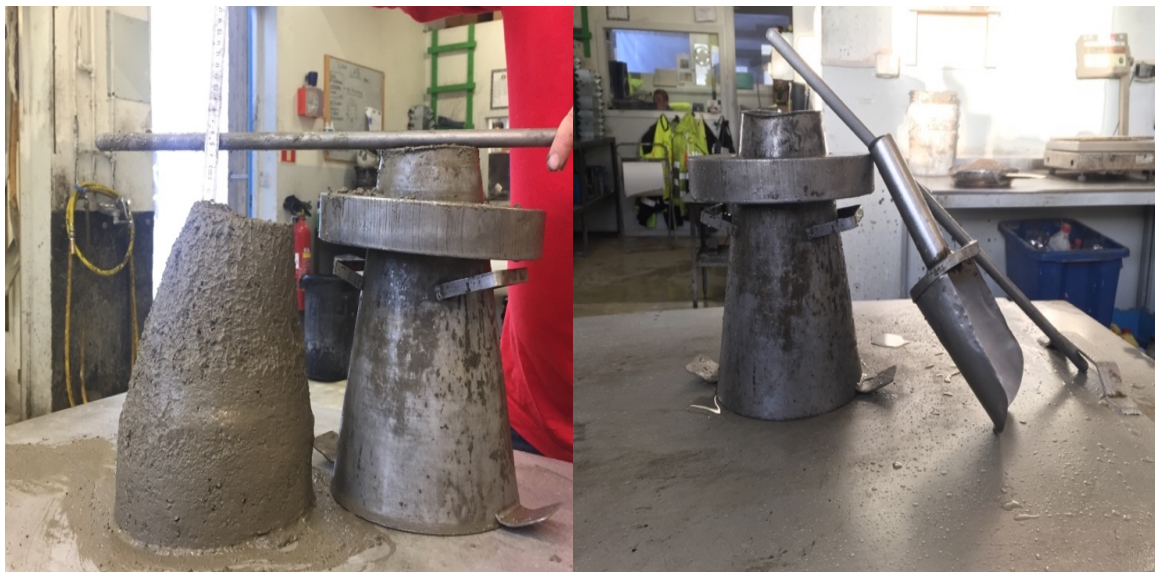
Figur 4-7. Måling av synk til venstre og utstyr til høyere.
