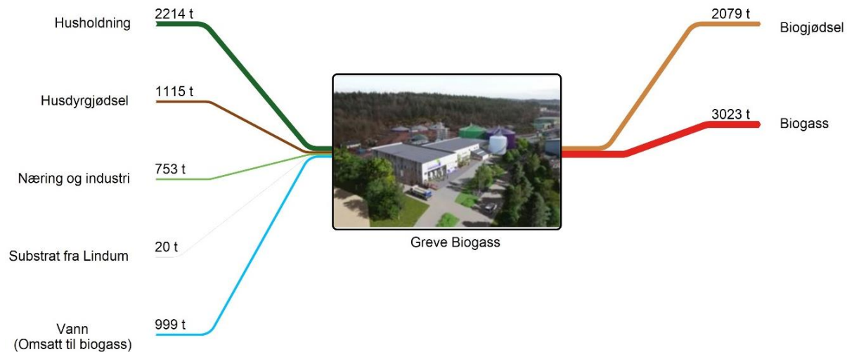
Figur 3. Massebalanse (tonn) for «tørrstoff» fra buffertank til ferdige produkter, biogjødsel og biogass ved Greve Biogass. I dette diagrammet er vann som forbrukes i den mikrobielle prosessen for å danne biogass inkludert (Hovland & Thomassen, 2017).
