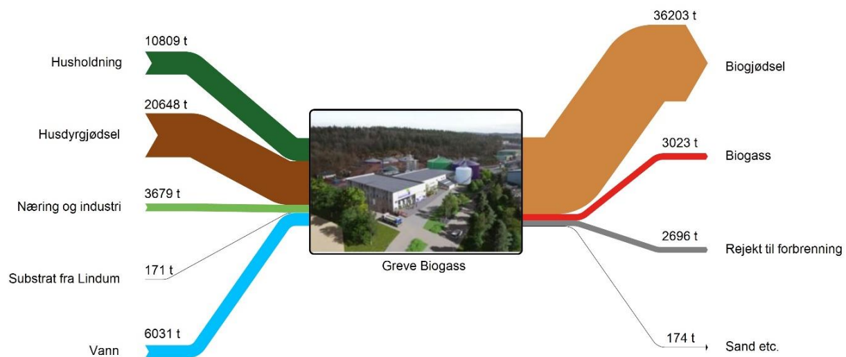
Figur 2. Massebalanse, totalvekt inkludert fuktighet og vann, for Greve Biogass. Sum for månedene februar til og med mai (Hovland & Thomassen, 2017).
