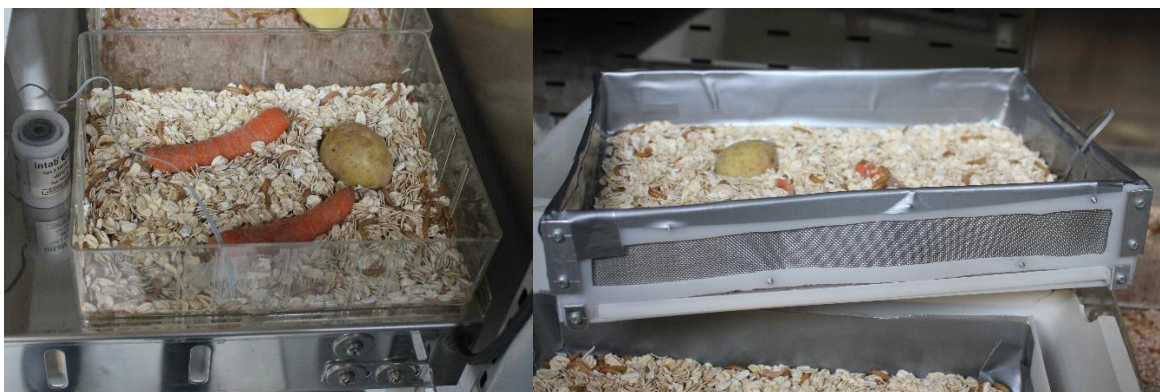
Figur 9.11 T.v: Kontrollboks, T.h: Prototypebokser plassert i klimaskap. Bilde: Eget foto.
