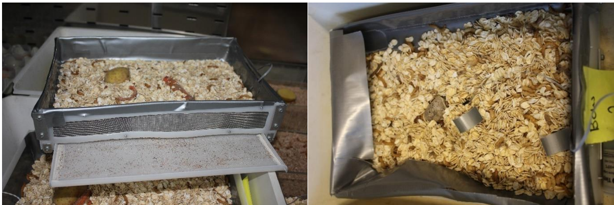
Figur 9.16 Vevteip ble benyttet for å tette netting og hull i nettingen som larvene kunne rømme gjennom. Etter kun noen dager kunne man se resultater som til høyre, hvor teipen har løsnet på grunn av bevegelsen til larvene. Silerfunksjonen er illustrert til venstre. Bilde: Eget foto.
