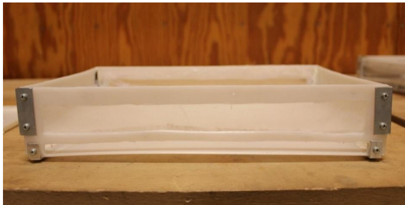
Figur 8.5 Plate på fremsiden av boksen. Det nederste hullet er hvor skuffen plasseres. Øverste hullet er for lufting. Bildet er tatt etter at den syrefaste nettingen ble byttet ut med nylonnetting. Bilde: Eget foto
