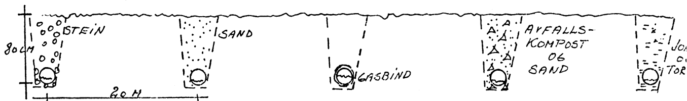
Fig. 5. Ulikt tilbakefyllingsmateriale over drenerør.
