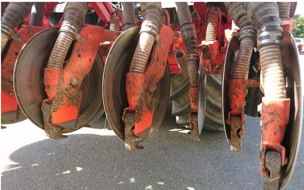
Figur 4: Sålabbar på direktesåingsmaskinen med skåler for å skjære gjennom planterestar og ned i jord som ikkje er løyst ved jordarbeid.
