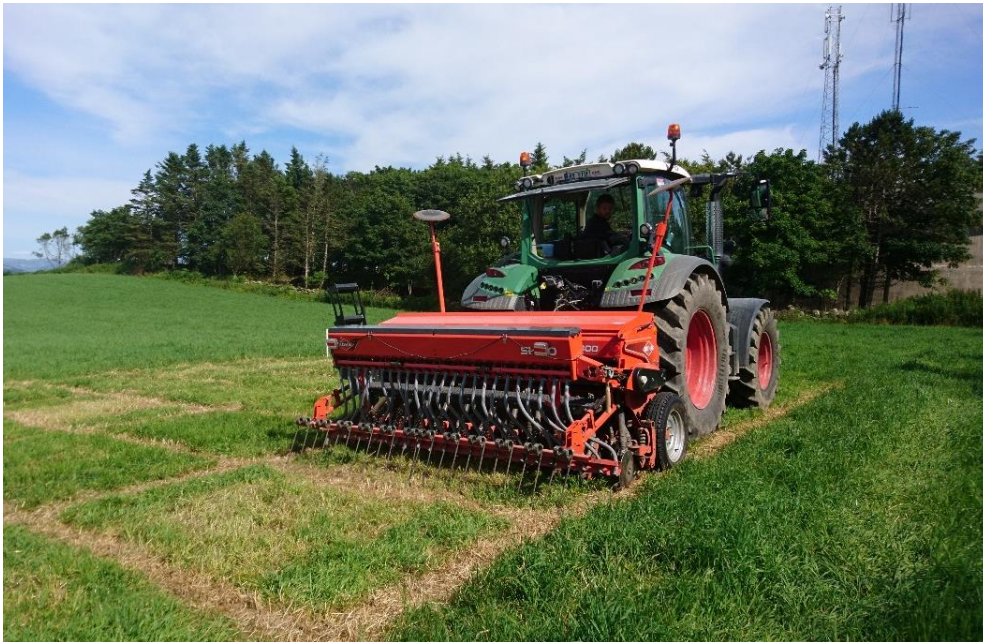
Figur 3: Kuhn premia 300 direktesåingsmaskin i aksjon på timoteifeltet. Den har 24 sålabbar med skåler, fulgt av ei rekke tinder, og ei arbeidsbreidd på tre meter,.
