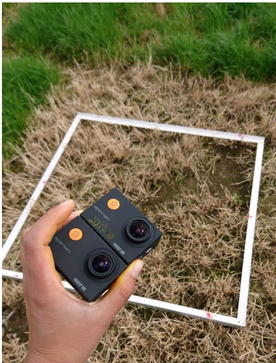
Figur 5: Kamera brukt til bildetaking i forgrunnen, og i bakgrunnen metallramma som markerte registreringsruta i forsøksruta.
