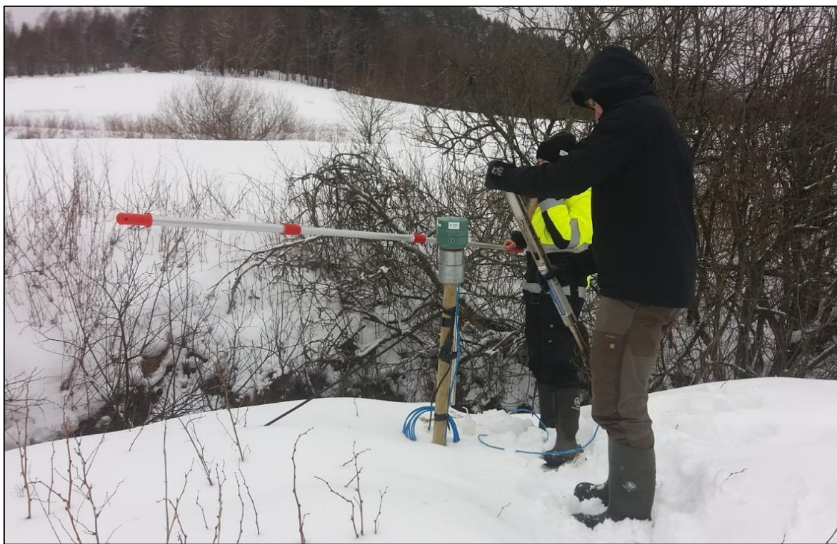
Figur 3.6: Vedlikehold og skiftning av batteriet til multiparametersensor nr. 3. Bildet er tatt 12.03.18
