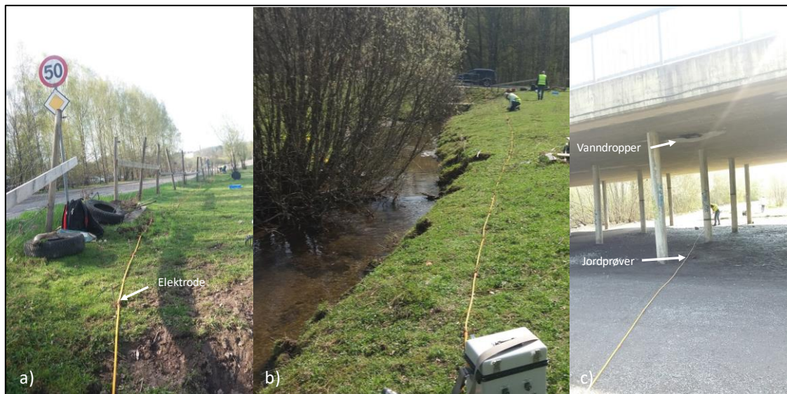
Figur 3.12: Plassering av ERT profiler a) ERT linjen nr. 1 parallell med Østensjøveien b) ERT linjen nr. 2 parallell til Bølerbekken c) ERT linjen nr. 3 under broen. Bilder er tatt 08.05.18.
