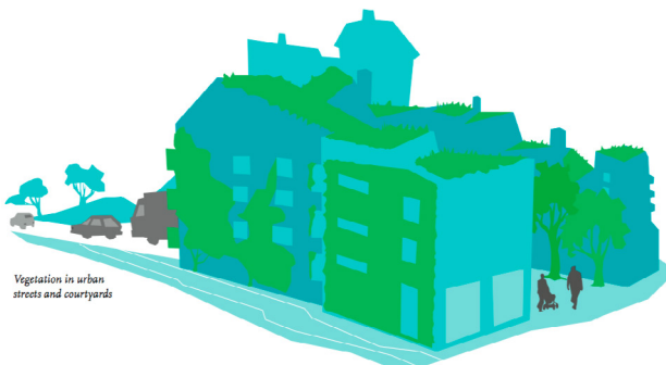
Fig. 36: Bruk av grønne tak og vegetasjon på fasader for støydemping og trivselsøkning (ibid.).
