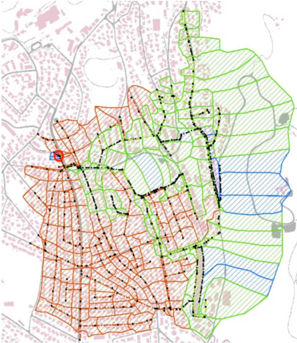
Figur 4.44. Kart som viser omådet som er tilknyttet overløpet AK52 (den røde sirkelen). Det er dette område den tidligere masteren har tatt utgangspunktet i. Rød farge viser fellessystem i område, men grønne og blå delfelt viser separatsystem (blå er overvann og grønn er spillvann).
