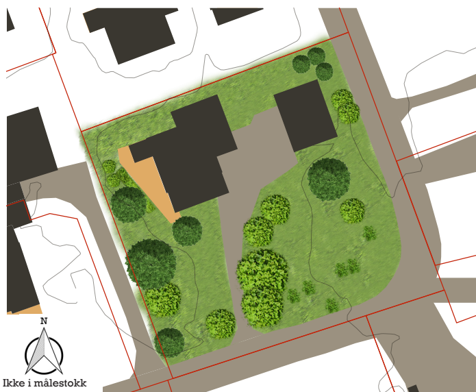
Figur 5.7. Enebolig med privat hage som egner seg godt til overvannstiltak og infiltrasjon av vann.
