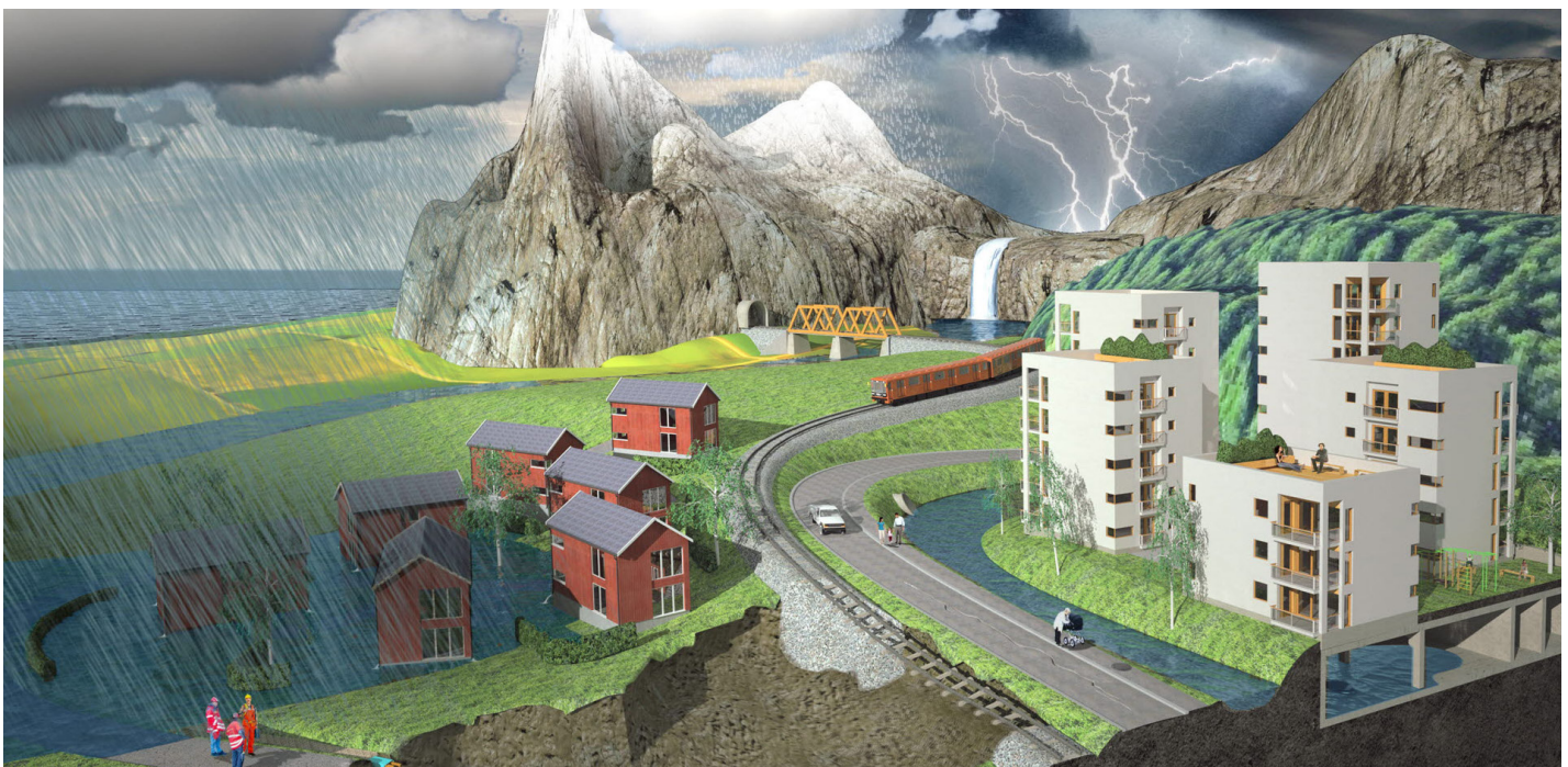
Figur 2.14. Samfunn som er robuste mot de forventede klimaendringene i framtiden er godt klimatilpasset. Bildet viser at infrastrukturen her ikke er særlig godt tilpasset endringene i klima fordi massene under jernbanen er erodert bort. I tillegg er det en kjelleroversvømmelse i boligblokkene.
