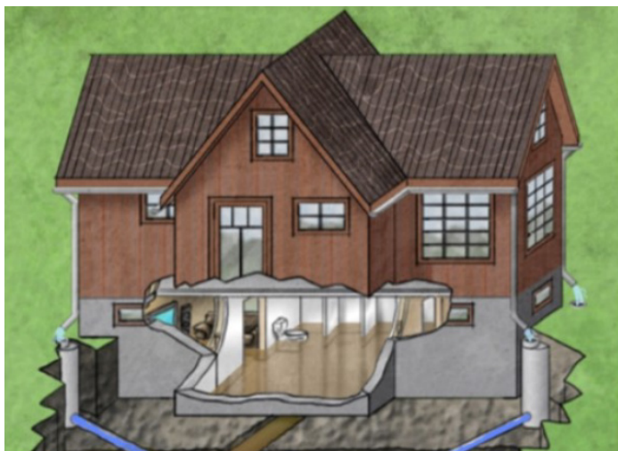
Figur 3.4. Bildet illustrerer en konsekvens av å ikke koble fra taknedløp.
