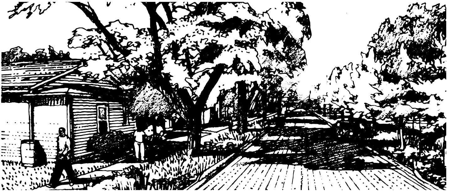
Figur 6.4. Å oppnå en god og bærekraftig overvannshåndtering er mulig i allerede eksisterende boligområder. Bildet viser et godt eksempel god overvannshåndtering i boligbebyggelse ved bl.a. bruk av bioswales langs veien.
