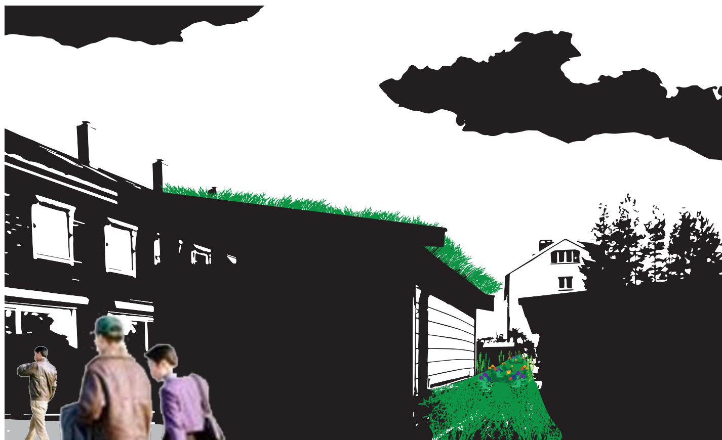
Figur 5.14. Illustrasjon av noen av overvannstiltakene på rekkehuset (grønt tak på søppelbod og bioswales mellom søppelbod og grasjehus som samler vann fra alle hagene samt garasjehuset).
