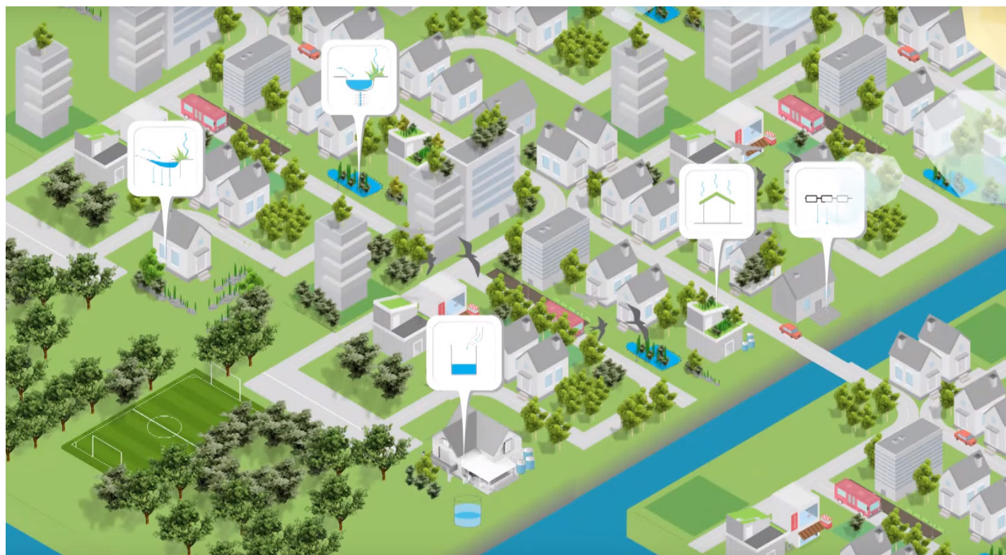
Figur 3.1. Dette bilde illustrerer hvordan det er brukt overvannstiltak på enkelte tomter i en boligbebyggelse. Dermed blir nedbøren håndtert der den faller og reduserer dermed den totale overvannsavrenningen.
