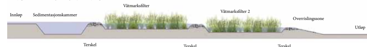
Figur. 1.11. Illustrasjon av en typisk fangdam brukt i jordbrukslandskapet. Urbane miljøer har vanligvis mindre tilgjengelig areal slik at en lommevåtmark blir en litt forenklet variant av en fangdam, mens hovedfunksjonene er i stor grad de samme.
