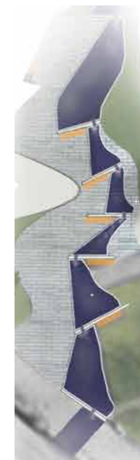
Figur. 1.3.13. Området i bakkene er bratt og det anlegges flere terskeldammer og småfusser nedover i terrenget.
