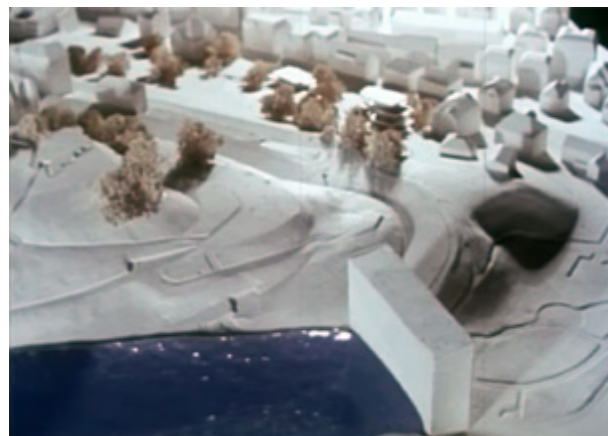
Figur 4.23. - 4.26. Bildene viser et forsøk fra Stuttgart der en kaldluftstrøm siger ned fra de skogklede dalsidene inn mot bysentrum. Simuleringen viser hva som skjer når kaldluft møter et hinder, i dette tilfelle en bygning (skjermbilder av video av Scheef, 1976).
