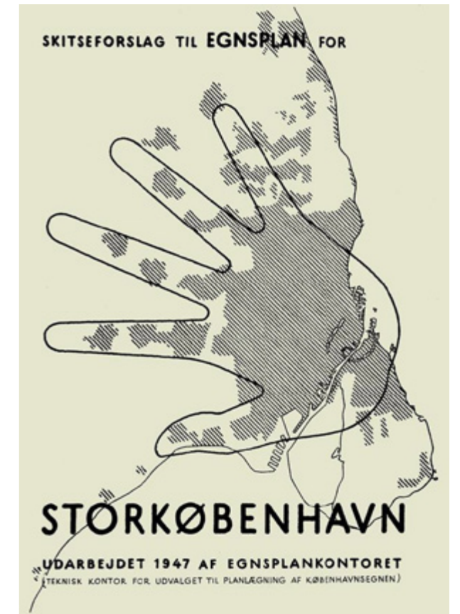
Figur 1.5. Etterkrigstidens byutvikling og økning i bil- og sykkeltrafikk fikk med Fingerplanen fra 1947 en arkitektonisk struktur av stor og langvarig betydning. Planen er den første danske byutviklingsplanen, og prinsippet var å konsentrere fremtidig byvekst langs en rekke hovedferdselskorridorer som strakte seg som fingre utover Sjælland fra bysentrum som utgjorde håndflaten. Mellomrommet mellom fingrene skulle ikke bygges ned, men bevares som friluftsområder med plass til både landbruksformål og rekreative funksjoner (Byplanlaboratorium 1993).
