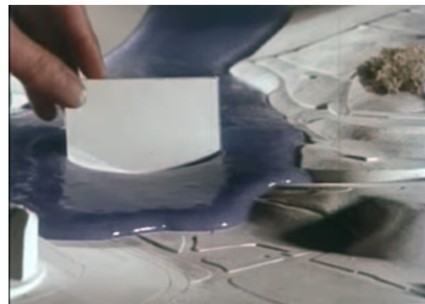
Figur 4.23. - 4.26. Bildene viser et forsøk fra Stuttgart der en kaldluftstrøm siger ned fra de skogklede dalsidene inn mot bysentrum. Simuleringen viser hva som skjer når kaldluft møter et hinder, i dette tilfelle en bygning (skjermbilder av video av Scheef, 1976).
