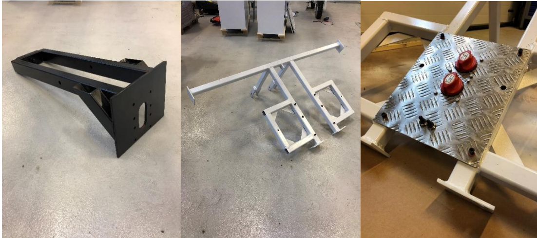
Figur 98: Til venstre ser man underrammen helsveiset og overflate behandlet med grunning og lakk. I midten ser man overrammen helsveiset og overflatebehandlet med grunning og lakk. Til høyre vises kontrollpanelet påmontert overrammen,
