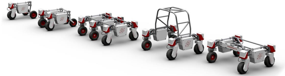
Figur 6: Flåten av de forskjellige type Thorvald som er bygd den dag i dag. Det finnes trehjulinger, firehjulinger og sekshjulinger ettersom hva man trenger. Det er også mulig å velge hvor mange hjul man ønsker trekk på [12].
