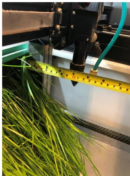
Figur 64: Testriggen med plantekaret plassert inn i laserkutteren. Laser hode justeres til den ønskede stubbehøyden 10 cm. (Eget foto)
