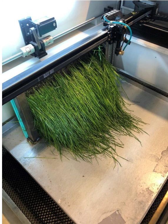
Figur 67: Resultatet etter å ha kjørt over med tre overkjøringer med sine respektive hastigheter på 300,150 og 50 mm/s. Viser liten eller ingen tegn til kutting. (Eget foto)
