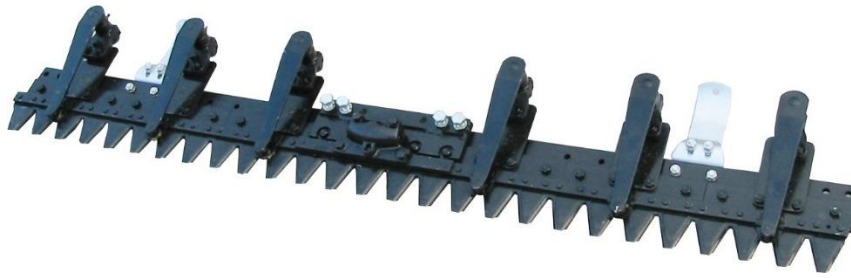
Figur 18: En knivbjelke typisk montert på tohjulstraktor [31].
