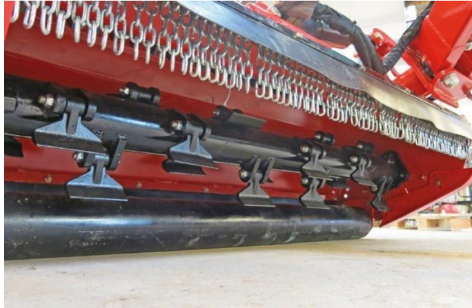
Figur 25: Traktormontert slagslåmaskin som er 140cm bred og krever en traktor på 50hk [36].
