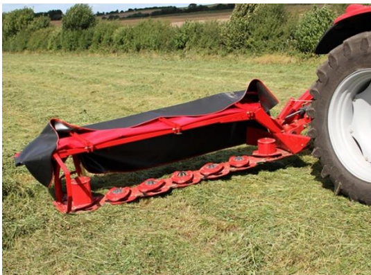
Figur 16: Til venstre ser man skiveslåmaskin mens til høyere ser sylinder slåmaskin [28] [29].
