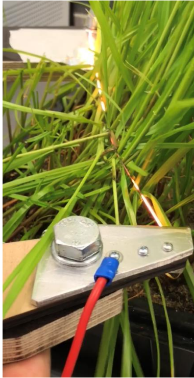
Figur 71: Varmetrådens påvirkning på graset med temperatur opp mot 800 grader celsius. (Eget foto)
