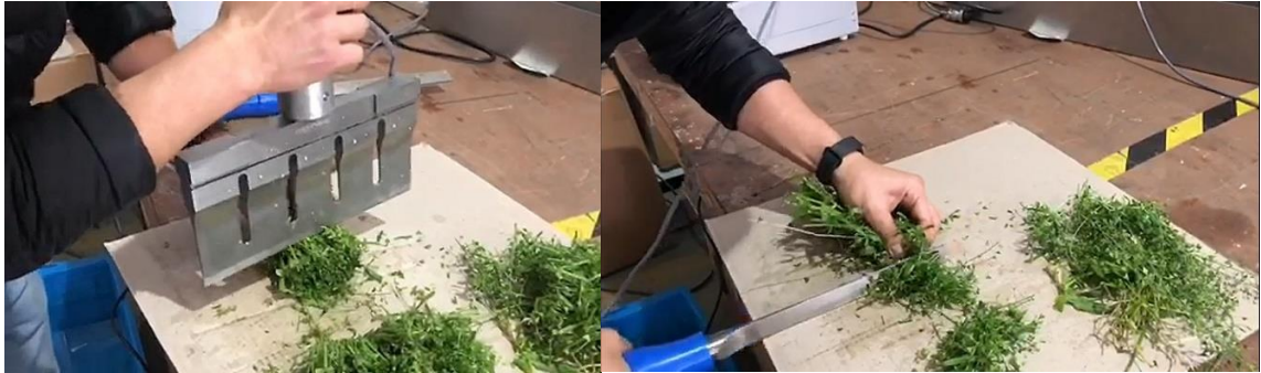
Figur 72: To forskjellige ultrasoniske kniver som kutter gras. Til venstre ser man en håndholdt kniv som vanligvis er installert på industrielle kuttemaskiner (UCF305), mens til høyre ser man en håndholdt kniv som er mer vanlig til personlig bruk (HFC300). (Foto: Cheersonic)
