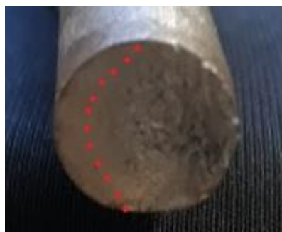
Figur 24 Striasjoner og restbrudd av en prøvestav
