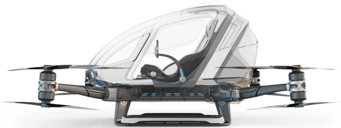
Figur 1.10: Ehang 184 vist fra siden, med gjennomsiktig eksteriør. Det viser et enkelt interiør for en person, med en skjerm festet til setet. [39]
