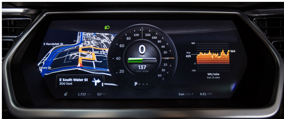
Figur 4.11: Instrumentpanel hos Tesla model S. Her er det flere muligheter for hva man ønsker å vise på siden av speedometeret, som for eksempel kart eller musikk som spilles.
