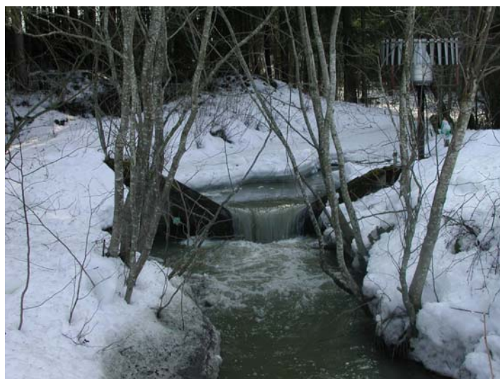
Målestasjon i Kolstadbekken om vinteren. Det er installert et v-overløp for registrering av vannhøyde.
